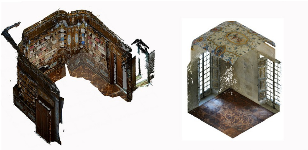
Abb. 50: „Digital Twin“, Fotogrammetrische Vermessung im Palazzo Quirinale (2022) und in der Villa della Regina (2023).
