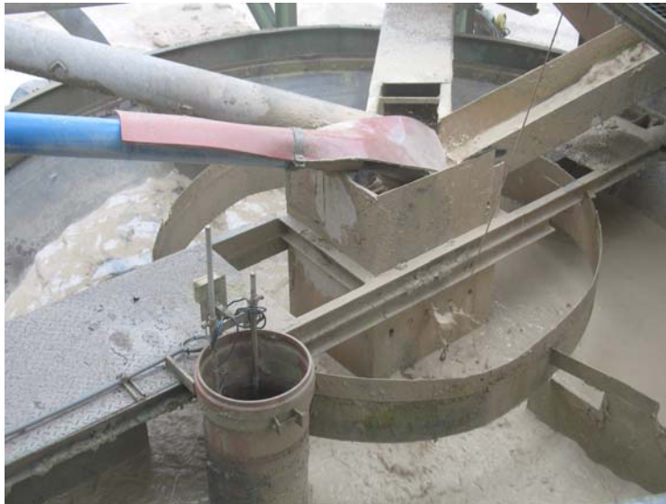
Abb. 38: Waschanlage des „Natursandes“ (li) und gereinigter „Natursand“ (re)
