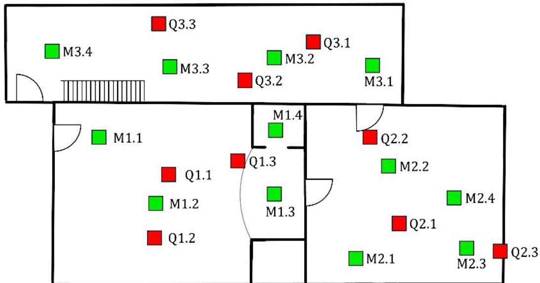
Abbildung 29: Positionen der Impulsschallquellen und der Messmikrofone für die Messung in der Ausstellung "Musikinstrumente" des Deutschen Museums, München; rot: Quellpositionen, grün: Messpositionen
