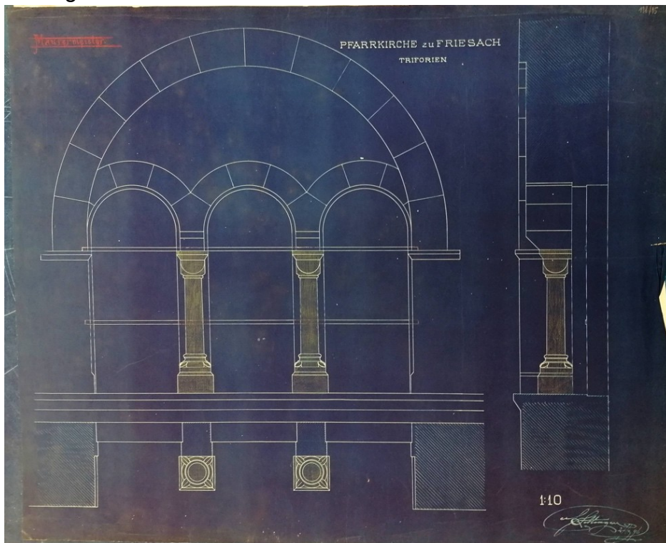
Abb. 75: Konstruktionsplanung der Triforien im Obergaden, 27.03.1896, Raymund Jeblinger.
