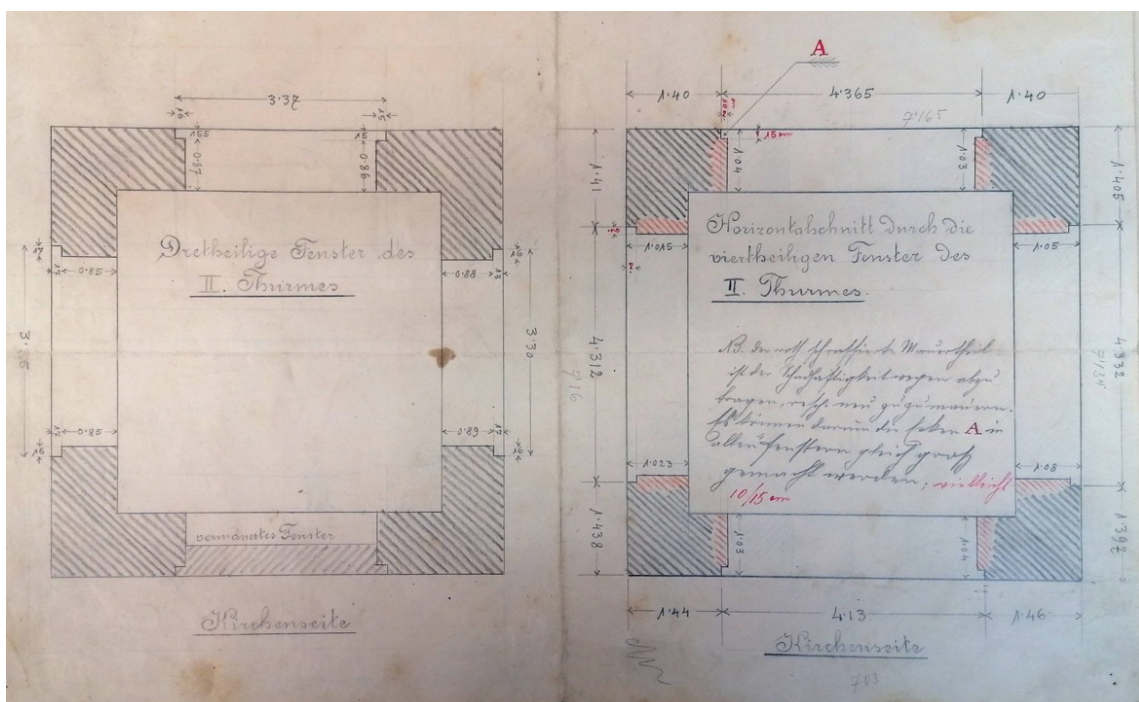
Abb. 34: Aufnahmezeichnung 2, Horizontaler Querschnitt der Türme mit Fensterdetails, 1895, Raymund Jeblinger.
