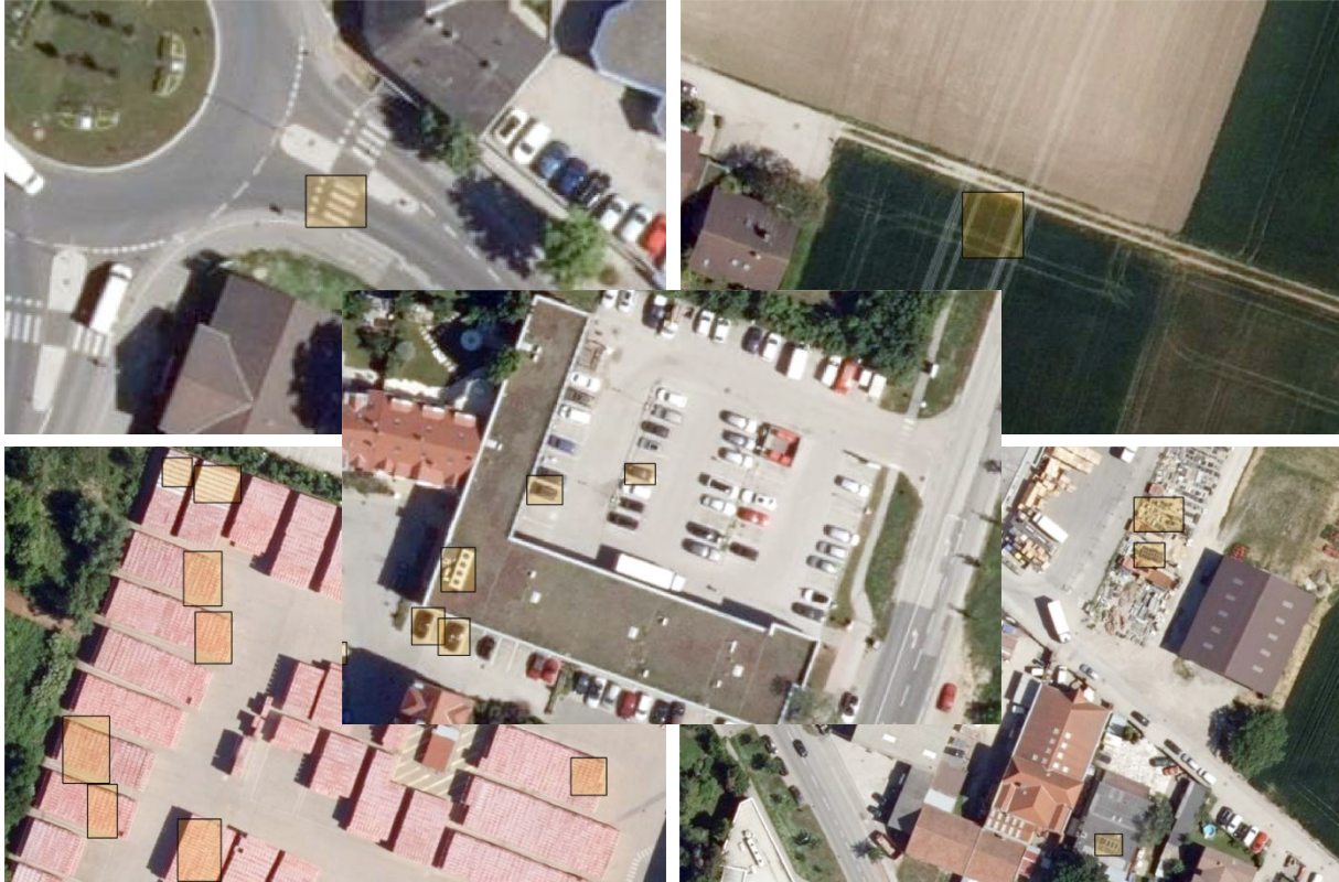
Abb. 94: Falsch als Photovoltaikanlage detektierte Objekte (Faster R-CNN) (Eigene Darstellung, erstellt mit ArcGIS Pro 3.2)
