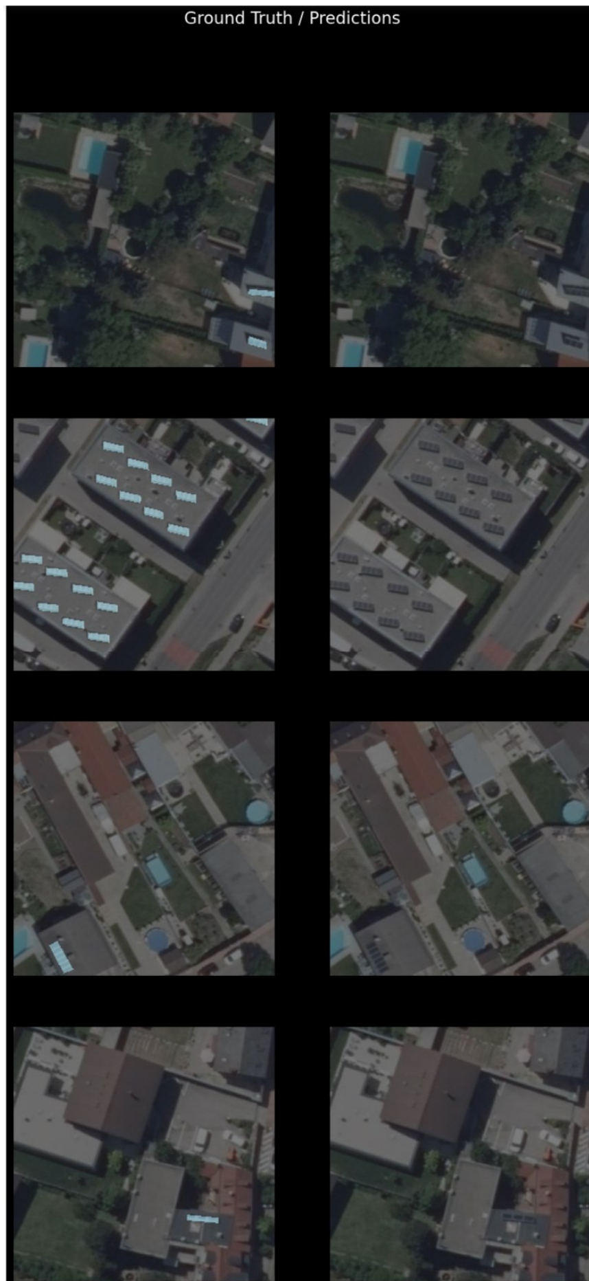
Abb. 83: Funktion show_results() für MaskRCNN mit Ground Truth (l.) und Vorhersagen (r.) (Kombinierter Datensatz, 10 Epochen, ohne Transformationen) (Eigene Darstellung, erstellt mit ArcGIS Pro 3.2)
