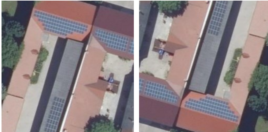
Abb. 42: Rotation einer PVA mit 0° (links) und 180° (rechts) (Eigene Darstellung, erstellt mit ArcGIS Pro 3.2)
