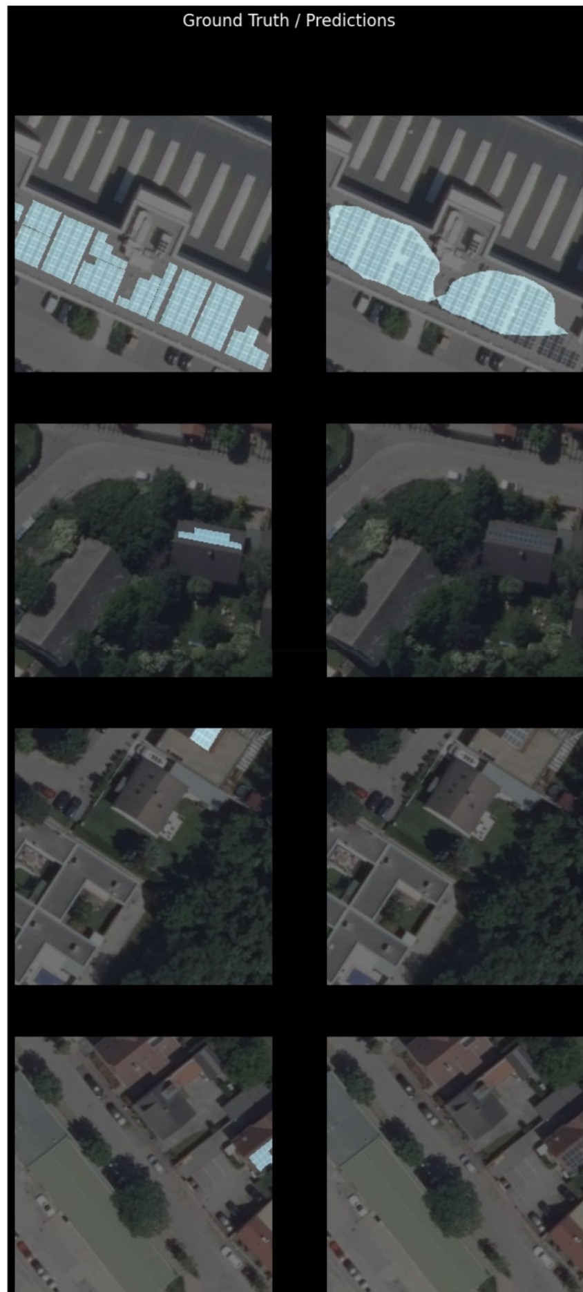
Abb. 73: Funktion show_results() für MaskRCNN mit Ground Truth (l.) und Vorhersagen (r.) (Datensatz 1, 10 Epochen, ohne Transformationen) (Eigene Darstellung, erstellt mit ArcGIS Pro 3.2)
