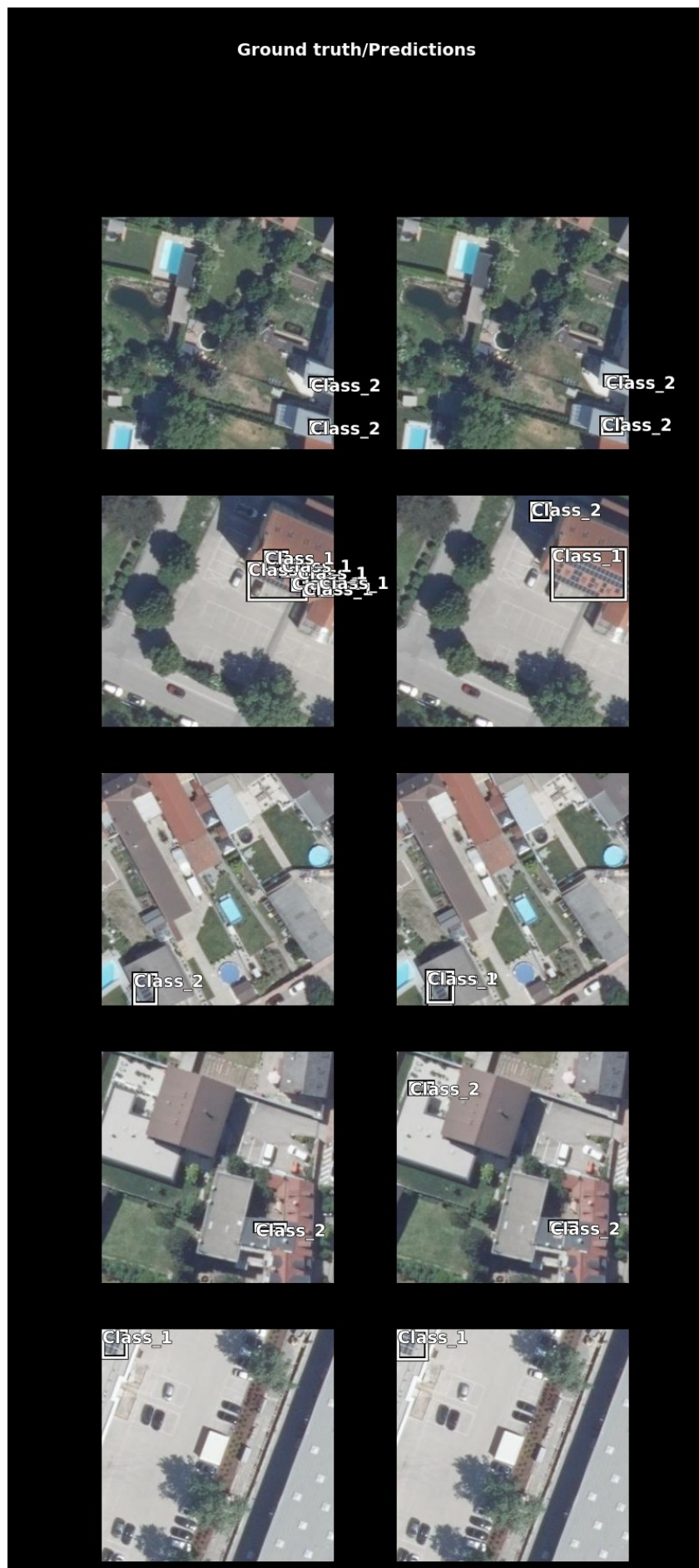
Abb. 65: Funktion show_results() für FasterRCNN mit Ground Truth (l.) und Vorhersagen (r.) (Kombinierter Datensatz, 10 Epochen, ohne Transformationen) (Eigene Darstellung, erstellt mit ArcGIS Pro 3.2)
