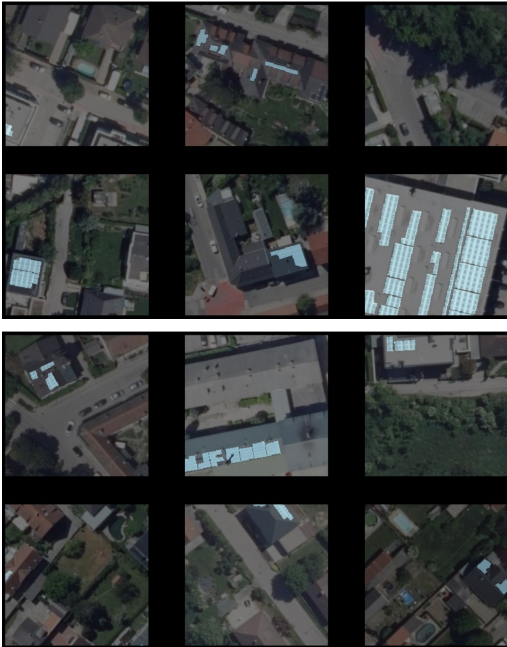
Abb. 69: Stichprobenartige Anzeige der Annotationen auf den Bilddaten in Datensatz 1 (MaskRCNN, 10 Epochen, ohne Transformationen) (Eigene Darstellung, erstellt mit ArcGIS Pro 3.2)
