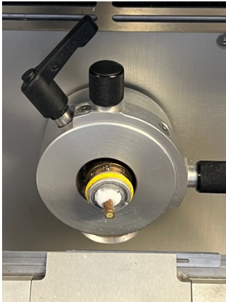
Abbildung 14: Einspannung des Stempels
