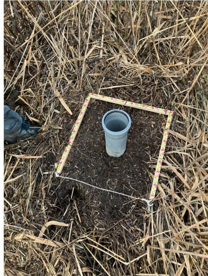
Bild 8: Erhebung der unterirdischen Biomasse mit einem Rohr aus Kunststoff. © Philipp Holzer
