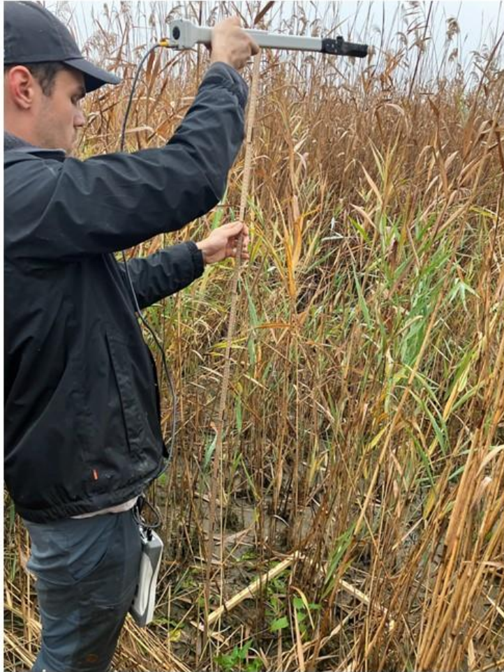
Bild 6: Messung des LAI mit dem LICOR 2200. © Hannah Steiner
