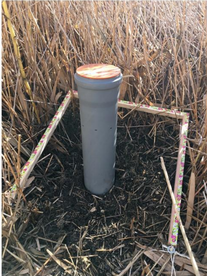
Bild 8: Erhebung der unterirdischen Biomasse mit einem Rohr aus Kunststoff. © Philipp Holzer
