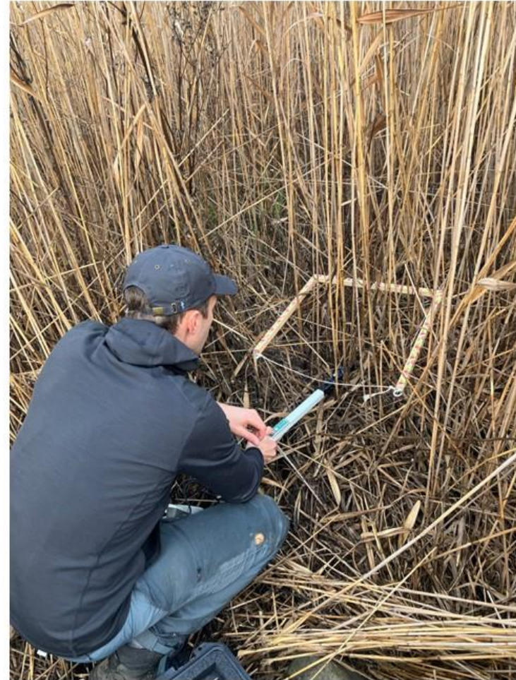
Bild 6: Messung des LAI mit dem LICOR 2200. © Hannah Steiner
