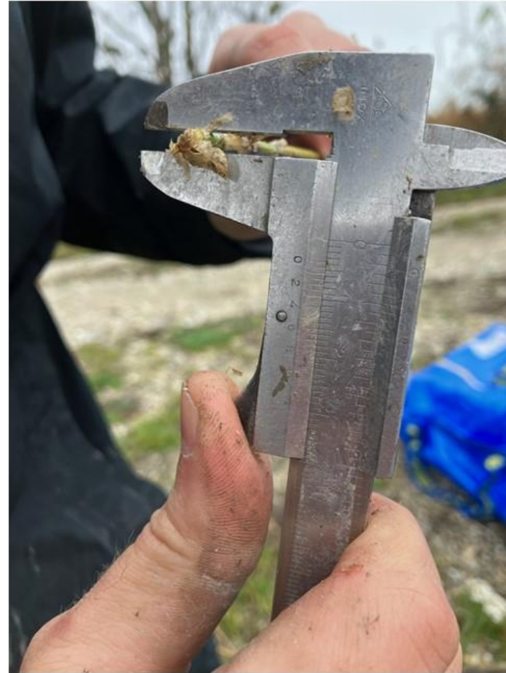
Bild 10: Ermittlung der Höhe der Halme mit einem Zollstock und des basalen Halmdurchmessers mit einer Schiebelehre. © Hannah Steiner
