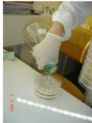
Abbildung 8: Gießen von Glucose-Minimal-Agar-Platten
