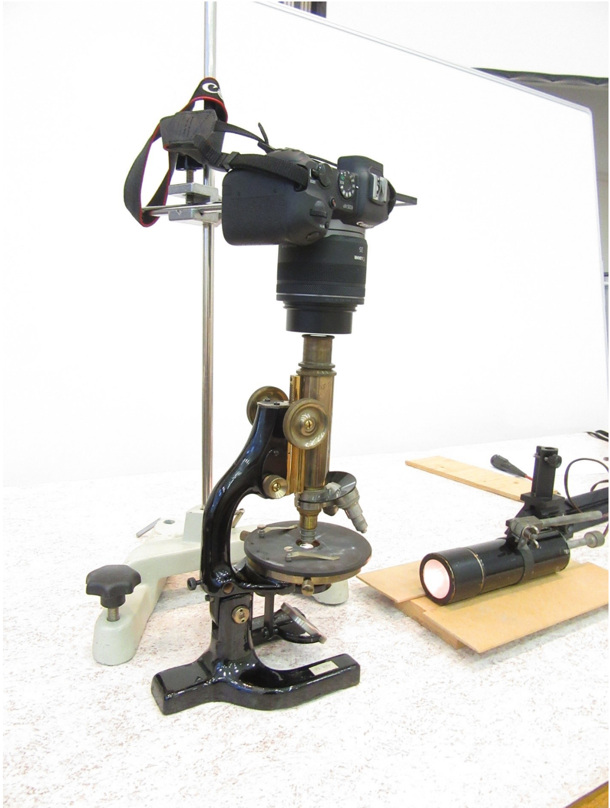
Abb. 43: Versuchsaufbau für die Bildaufnahme eines Kupferdrahtes
