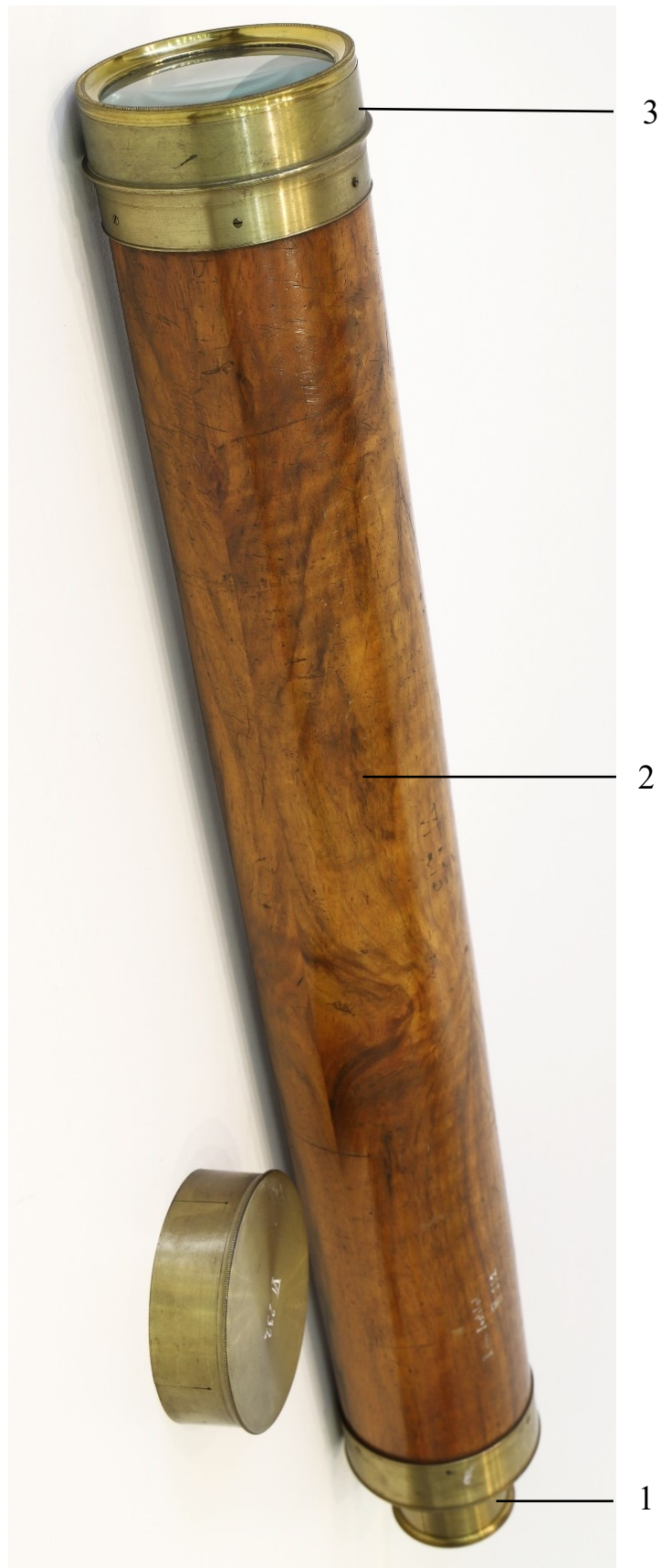
Abb. 146: Kometensucher: 1 Okular, 2 Tubus, 3 Objektiv
