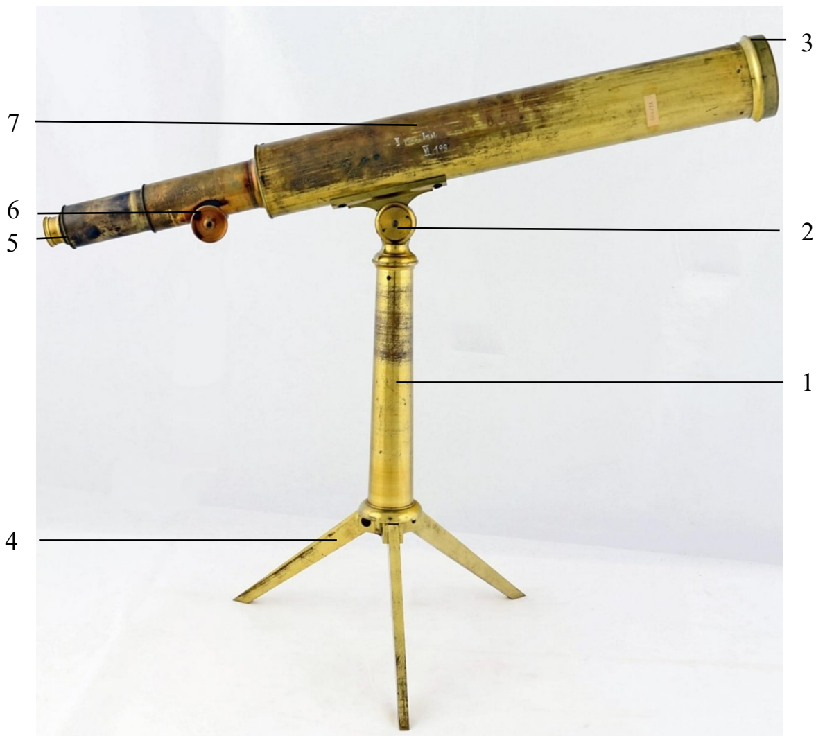
Abb. 125: Plössl-Fernrohr: 1 Stativ, 2 Kippgelenk, 3 Objektiv, 4 Standbein, 5 Okular, 6 Einstelltrieb, 7 Tubus
