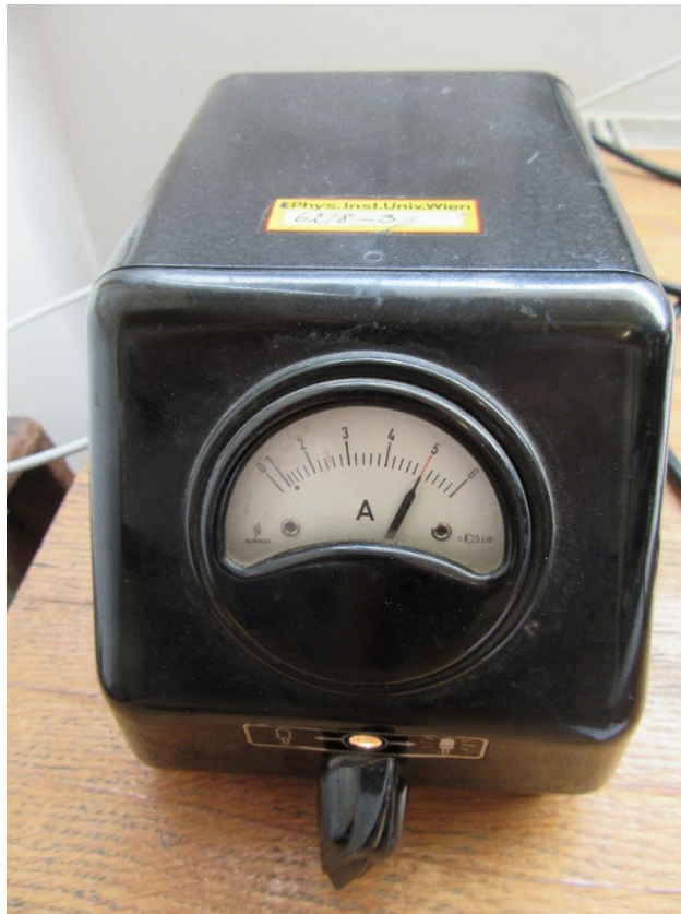
Abb. 60: Regeltransformator für den Lampenstrom
