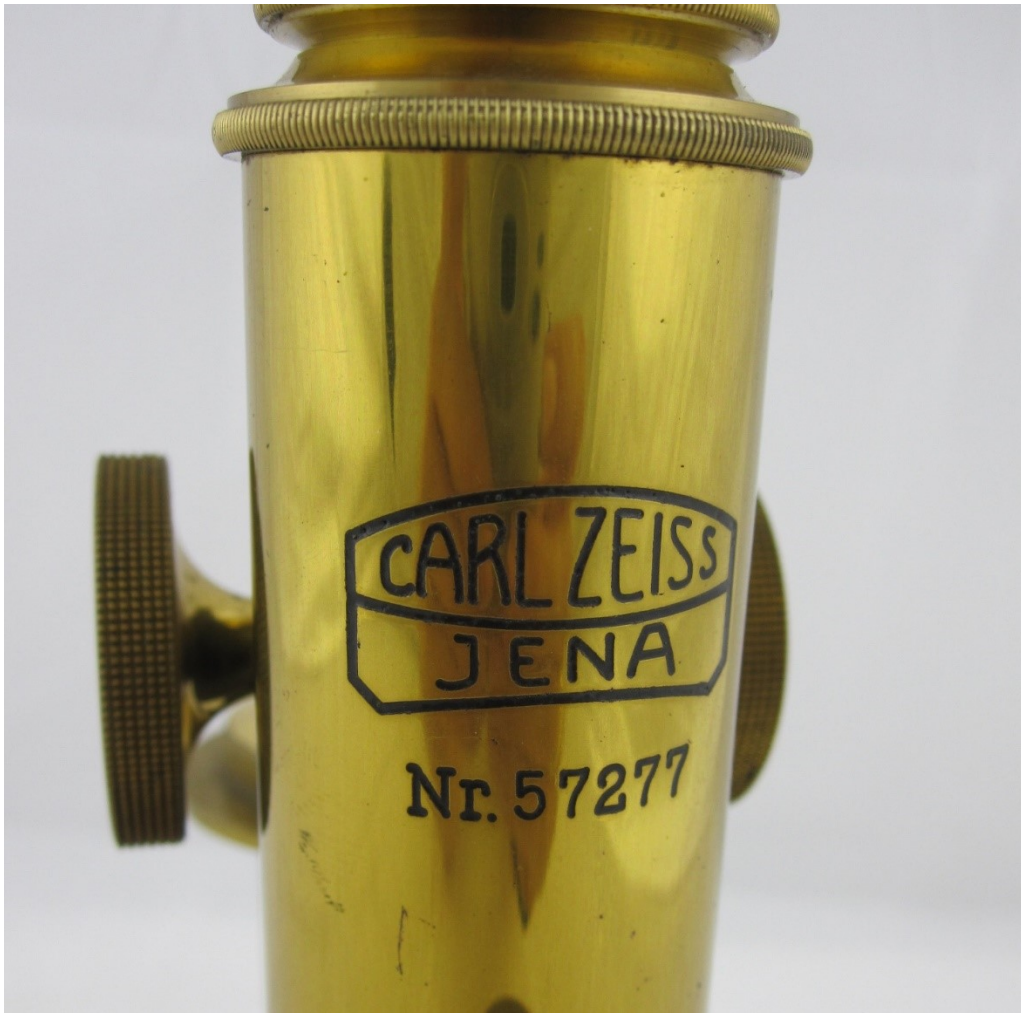
Abb. 71: Tubus mit Seriennummer und Grobtrieb
