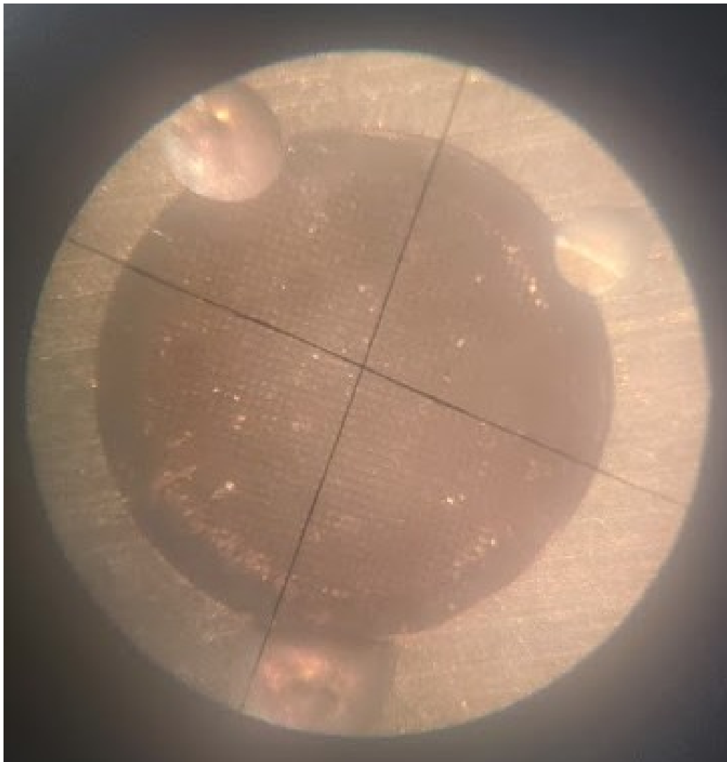
Abb. 96: Kreuzgitter mit 3,0 mm Durchmesser bei 35-facher Vergrößerung
