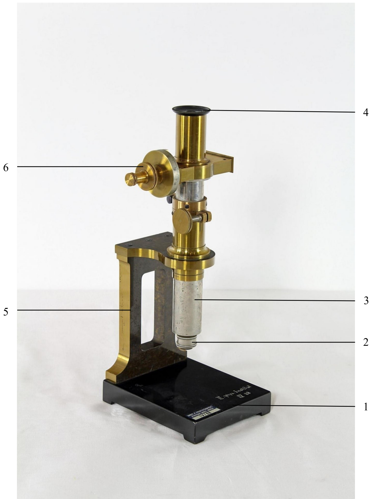
Abb. 104: Aufbau des Mikroskops: 1 Standfläche, 2 Objektiv, 3 Tubus, 4 Okular, 5 Stativ, 6 Skalentrommel für Dickenmessung
