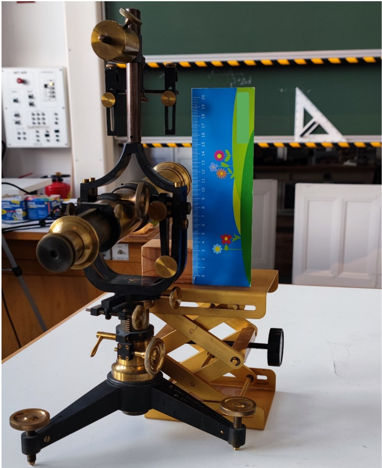
Abb. 120: Versuchsaufbau zur Bestimmung der Fernrohrvergrößerung nach Methode aus Kapitel 6.4
