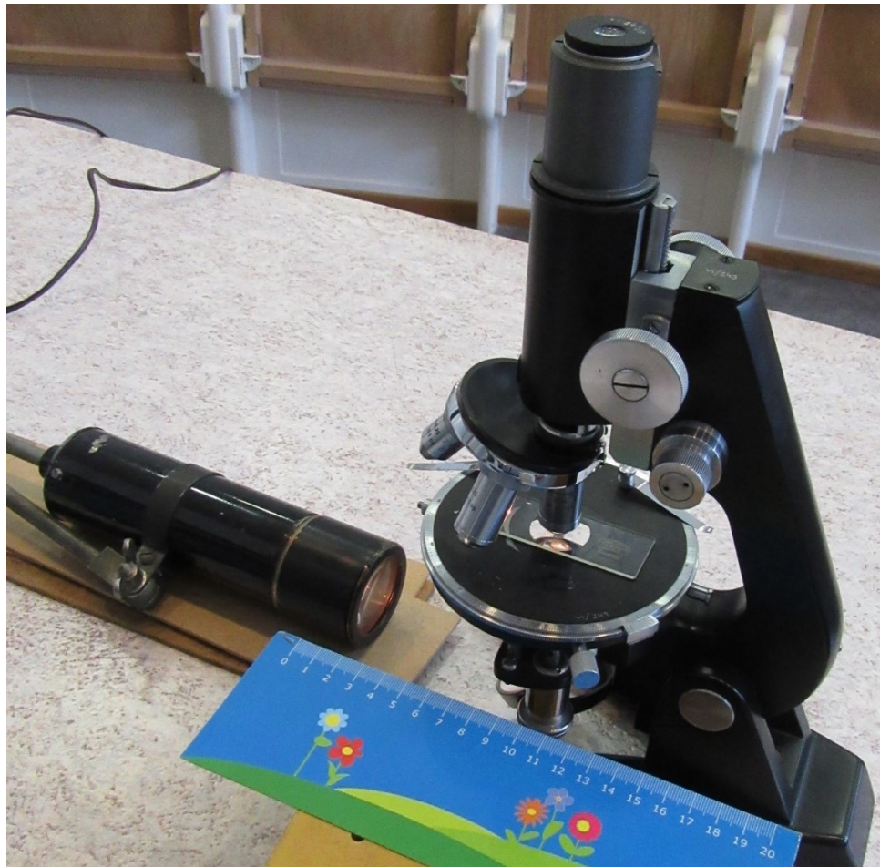
Abb. 53: Bestimmung der Gesamtvergrößerung nach Methode aus Kapitel 6.4
