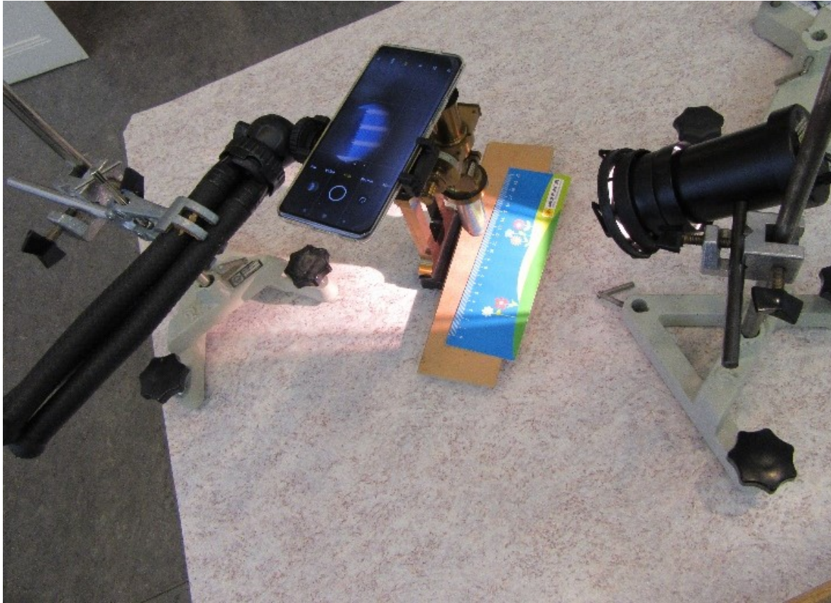
Abb. 105: Aufbau zur Ermittlung der Kalibrierung
