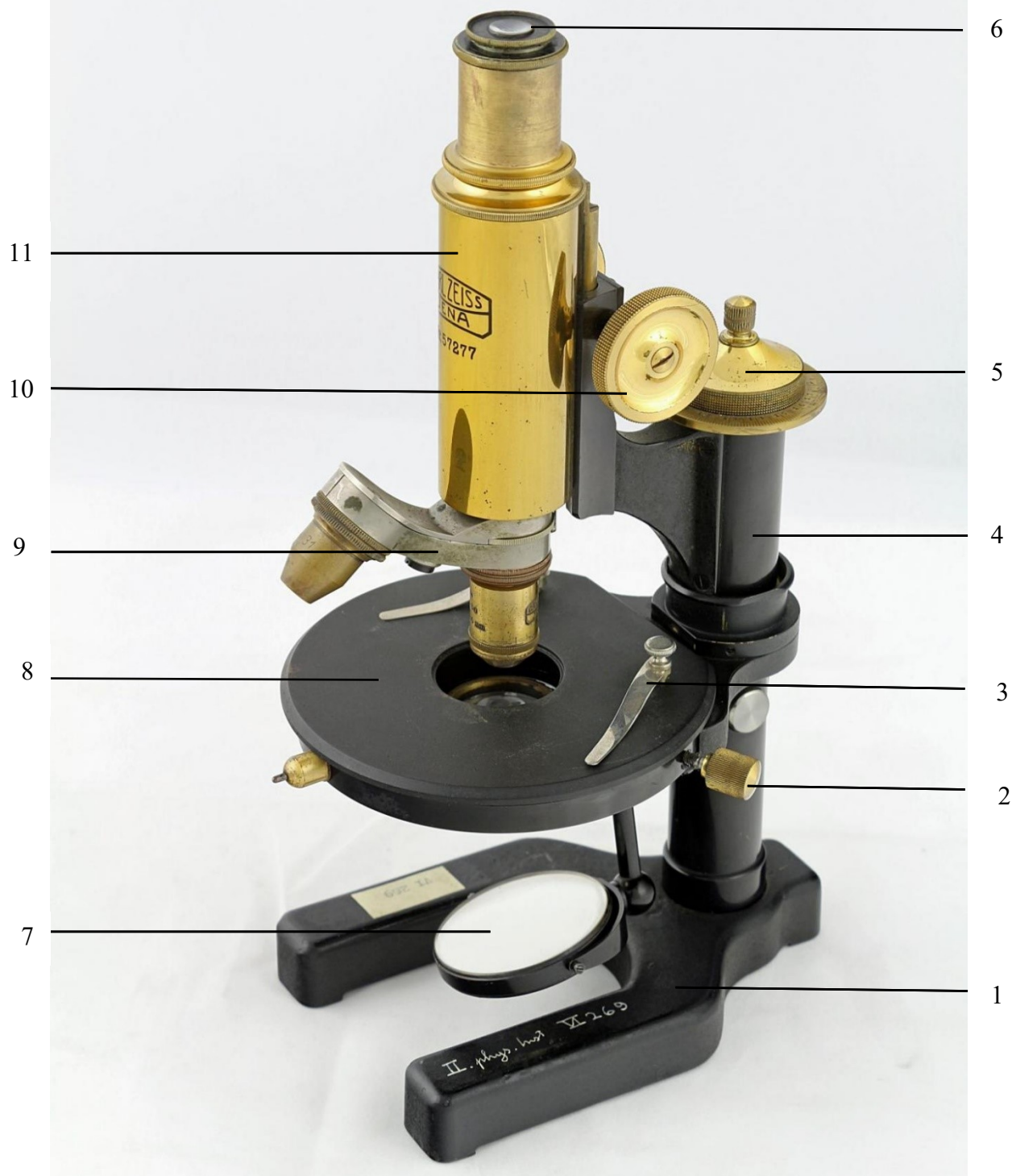
Abb. 69: Aufbau des Mikroskops: 1 Zweiarmiges Standbein, 2 Stellschraube für Probentisch, 3 Fixierklammern für Probe, 4 Stativ, 5 Feintrieb, 6 Okular, 7 Hohl- und Planspiegel, 8 Probentisch, 9 Zweifachrevolver mit Objektiven, 10 Grobtrieb, 11 Tubus
