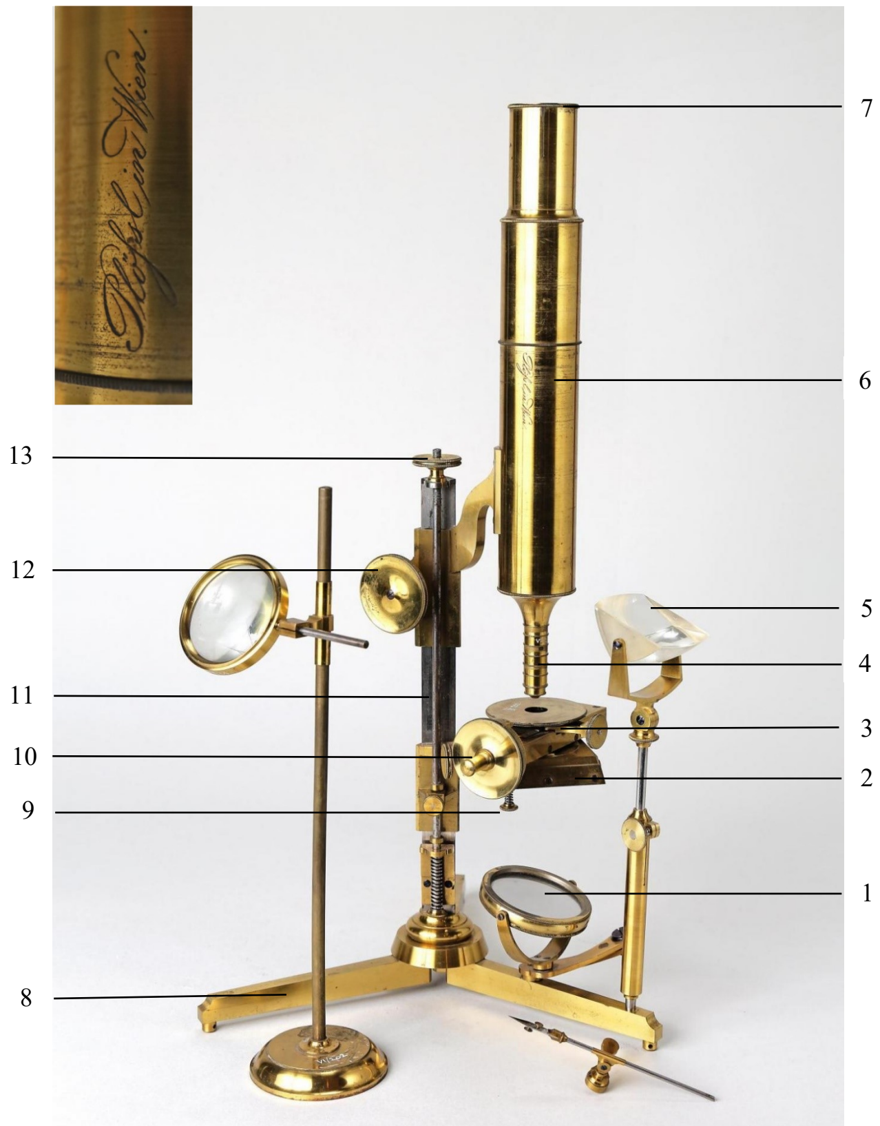
Abb. 83: Aufbau des Mikroskops: 1 Hohlspiegel, 2 Probenstisch, 3 Zweiter Probenstisch, 4 Objektive, 5 Prisma, 6 Tubus, 7 Okular, 8 Dreiarmiges Standbein, 9 Schraubenfeder, 10 Rad mit Skalierung, 11 Dreikantstativ aus Stahl, 12 Grobtrieb, 13 Feintrieb
