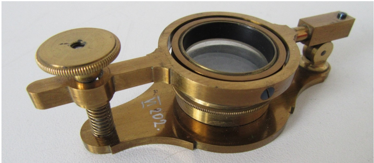
Abb. 91: Zwei Gläser, das obere ist kippbar, zur Manipulation der Beleuchtung
