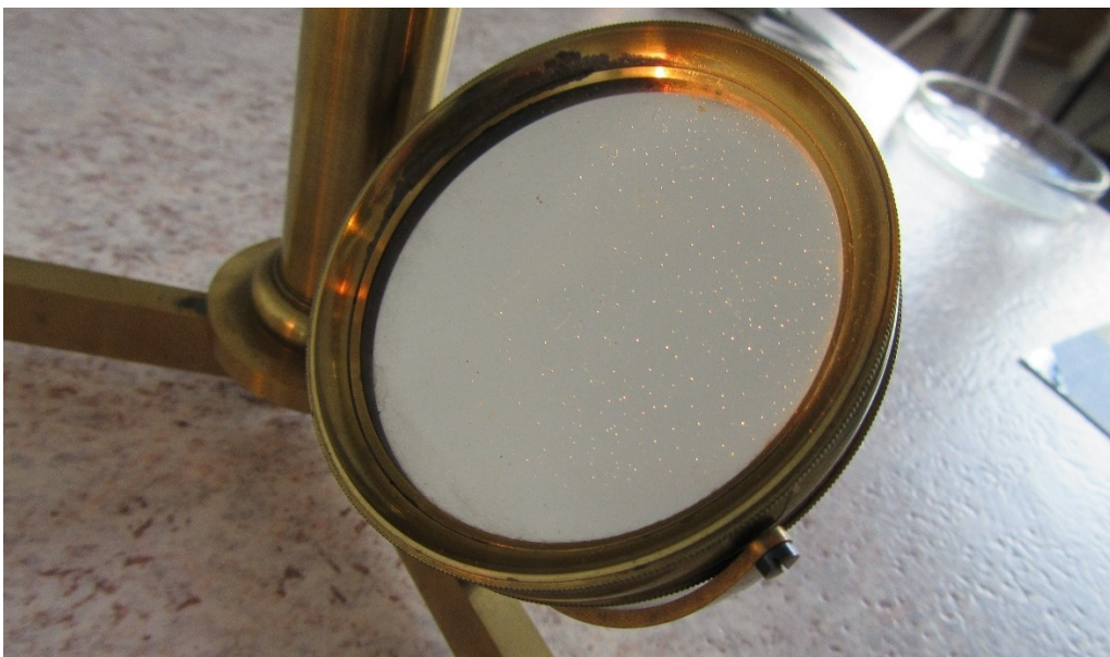
Abb. 82: Leicht schadhafter Hohlspiegel für Durchlicht
