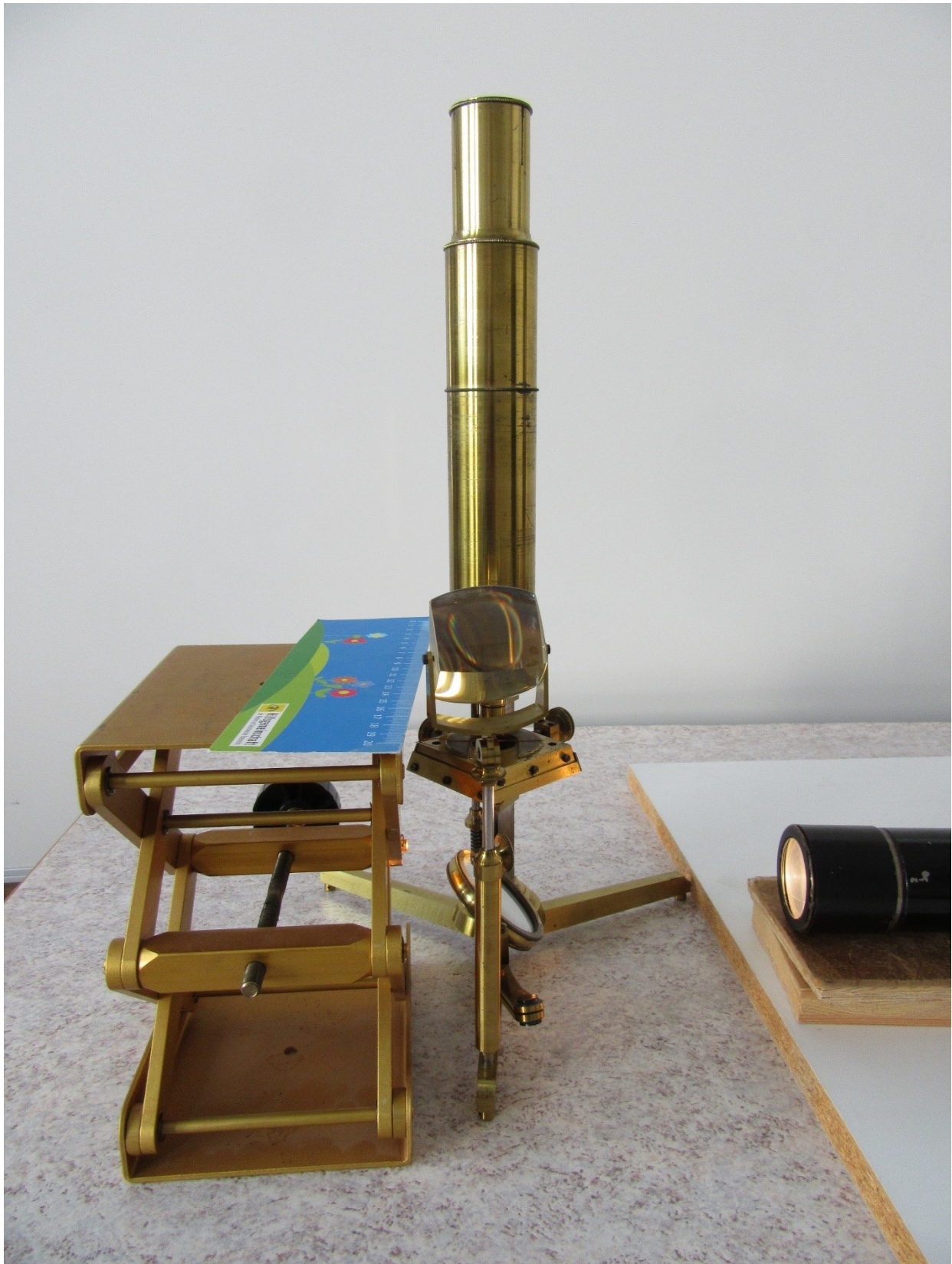
Abb. 93: Versuchsaufbau zur Bestimmung der Gesamtvergrößerung nach Methode 6.4
