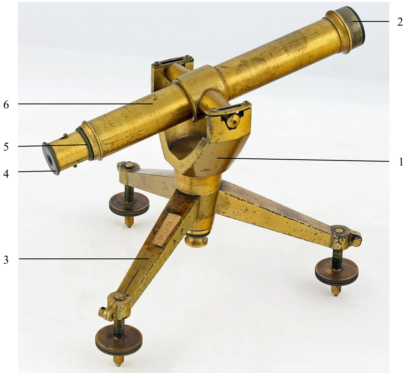
Abb. 142: Aufbau des Fernrohres: 1 Stativ, 2 Objektiv, 3 Dreiarmliges Standbein, 4 Okular, 5 Ausziehbares Okularstück, 6 Tubus
