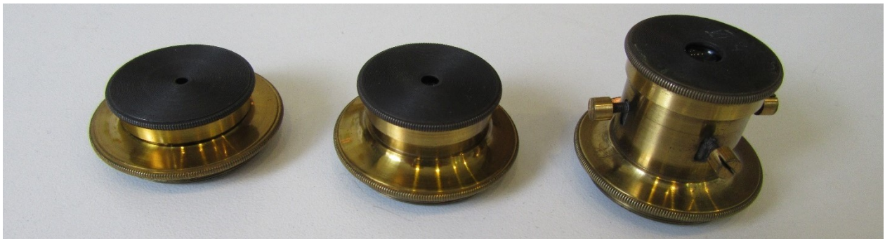
Abb. 137: Okulare (Links 1, Mitte 2, Rechts 3)
