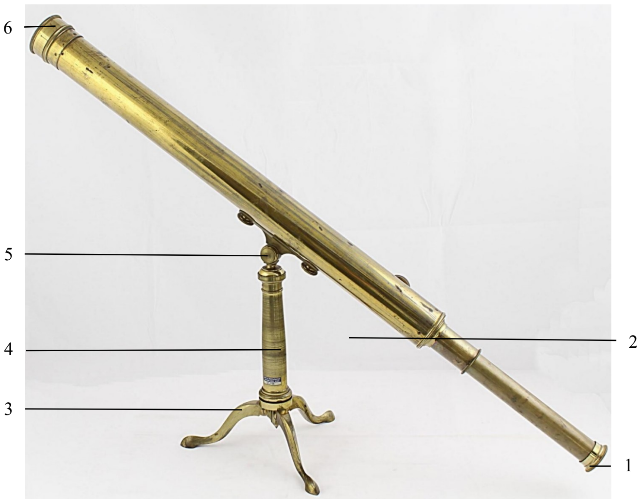
Abb. 132: Aufbau des Fernrohres: 1 Okular, 2 Tubus, 3 Dreiarmliges Standbein, 4 Stativ, 5 Kippgelenk, 6 Objektiv mit Kappe
