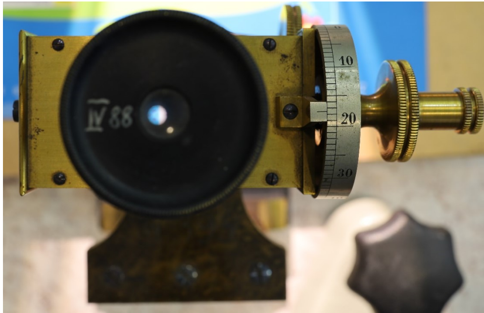
Abb. 108: Skalentrommel zur Justierung der im Tubus angebrachten Skala
