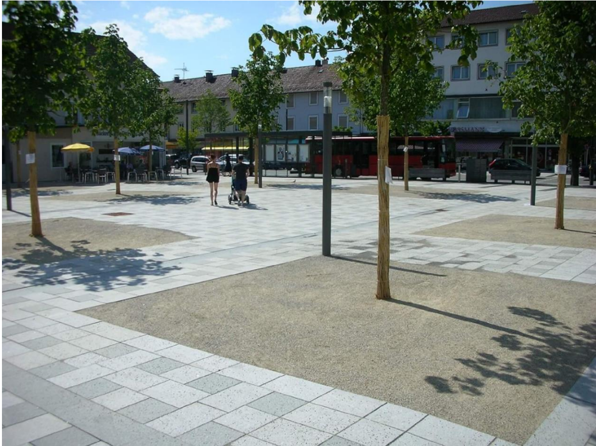
Abbildung 23: Entsiegelung durch wassergebundene Decken, Quelle: Hermann Kutter GmbH & Co. KG 2021: o.S.
