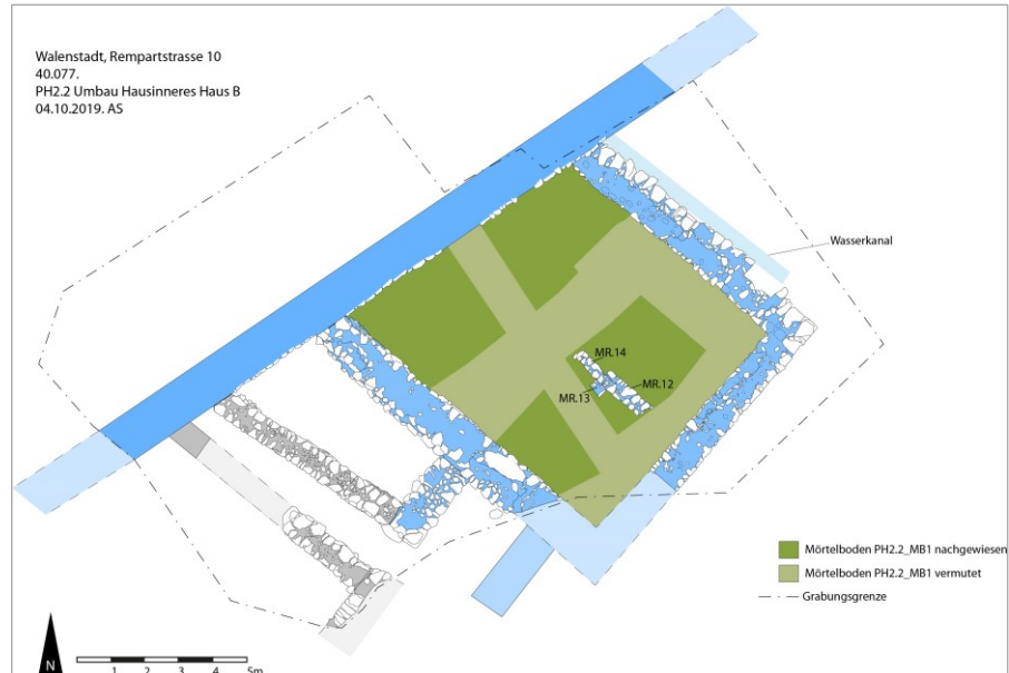
Abbildung 29: Walenstadt, Rempartstrasse 10: Ausdehnung der Rollierung PH2.2_RL1 ist gleich der Ausdehnung des Mörtelbodens PH2.2_MB1. Mauern 12-14 standen auf der Rollierung, der Mörtelboden zog an sie heran.
