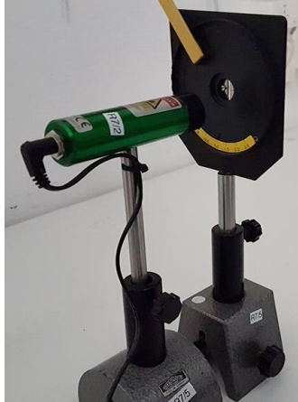
Abbildung 2: Experimentelle Lernumgebung zur Beugung mit Rotlicht-Laser (nicht abgebildet), Grünlicht-Laser und verstellbarem Spalt.
