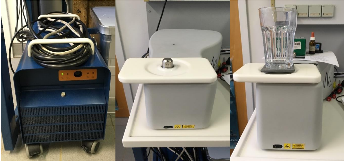
Abb. 15: Bestandteile des Raman-Spektrometers: Power-Unit, Analyser, Analyser während einer Messung (v.l.n.r)
