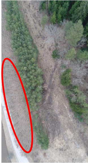
Abbildung 50: Dünne Laubbäume wie Pappeln können bei höherer Flughöhe nicht dreidimensional erfasst werden. [eigene Abbildung]
