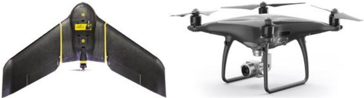
Abbildung 17: Gegenüberstellung von Fixed Wing UAVs (SenseFly eBee Plus) und Rotary Wing UAVs (Phantom 4 Pro) [SEN-18a / DJI-18]
