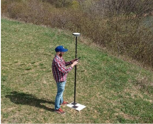
Abbildung 33: Setzen von Ground Control Points mit Hilfe eines Leica GG04 Plus GNSS-Geräts [eigene Abbildung]
