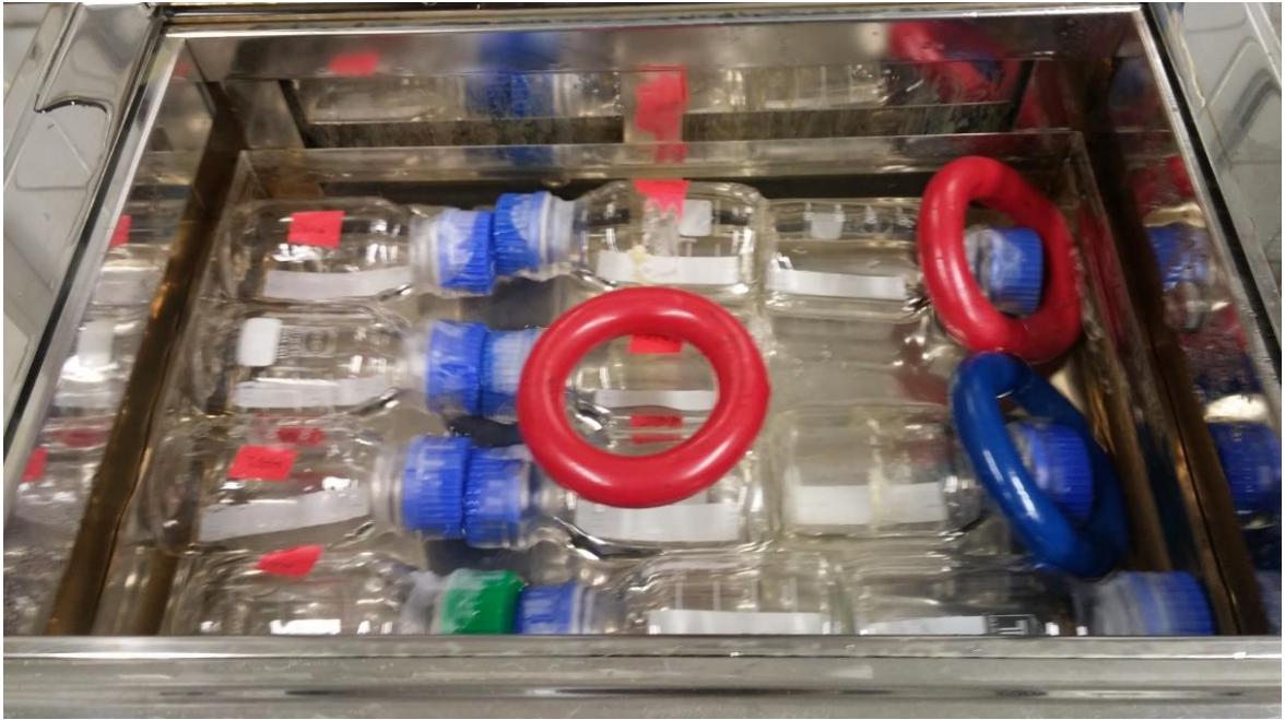
Abbildung 18: Inkubation der Blots mit Stripping Puffer und \beta -Mercaptoethanol bei 56°C im Wasserbad.
