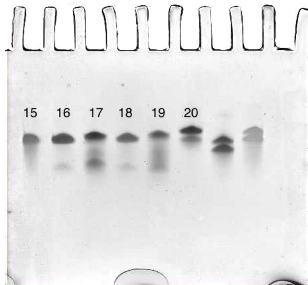
Abb. 4.2.3. zeigt das Gel der nach dem ursprünglichen Set aus 14 Substanzen abgeänderten, neuen Antisense-Stränge. Die beiden nicht beschrifteten Banden rechts sind andere Nukleinsäuren, die am gleichen Gel mitliefen. Verglichen mit den beiden vorigen Versuchen, zeigen sich hier große Unterschiede in der Synthesequalität. Substanz 20 ( 2'-O-Me (Pyr) C new ) ist durch die 3'-Cholesterin-Kopplung wieder etwas höher gelegen als der Rest, jedoch weist diese hier eine eindeutige zweite Bande auf. Auch bei den Strängen 16 ( ohne seed region new ), 17 ( terminal (AS gapmer) new ) und 18 ( alternierend new ) findet sich eine gut zu sehende zweite Bande, welche insbesondere auf Fehlsequenzen durch einzelne unvollständige Kopplungen hindeutet. Die Konzentrationen der verkürzten Produkte scheinen jedoch gemessen an ihrer Bandenintensität wesentlich geringer zu sein, als jene der vollständigen Antisense-Stränge, die auf erwarteter Höhe der Migrationsstrecke zu sehen sind.
