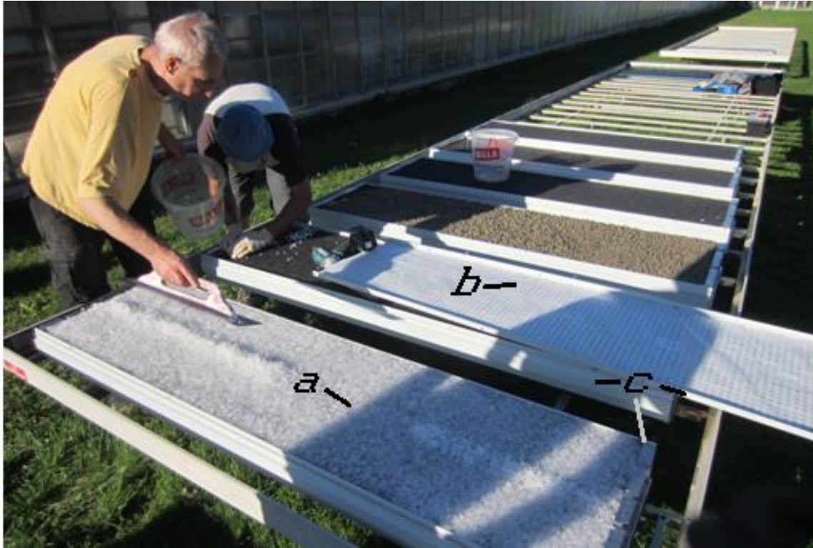
Abb. 11: Bestandteile der Paneele: a...Granulat, b...Fließ, c...Metall-Grundgerüst (E.H. bearbeitet von J.G.)
