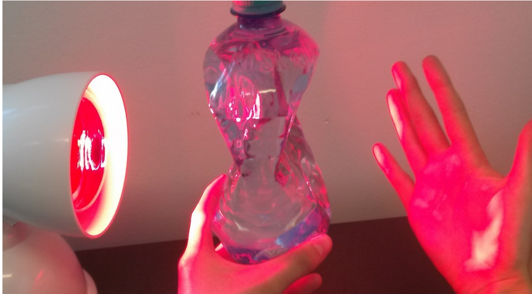
Abbildung 14: IR-Lampe beleuchtet die bloße Hand mit Hindernis
