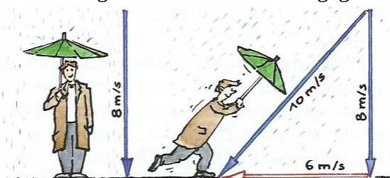
Abb. 4.13: Wenn du läufst, addieren sich die Geschwindigkeiten. Weil es sich um ein rechtwinkeliges Dreieck handelt, kannst du mit Pythagoras rechnen: \sqrt{6^2 + 8^2} = \sqrt{36 + 64} = \sqrt{100} = 10 . Eine solche Konstruktion nennt man Vektordreieck .
