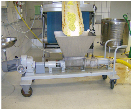
Abb. 16: Walzenmühle Vorderansicht und Befüllung der Pumpe
