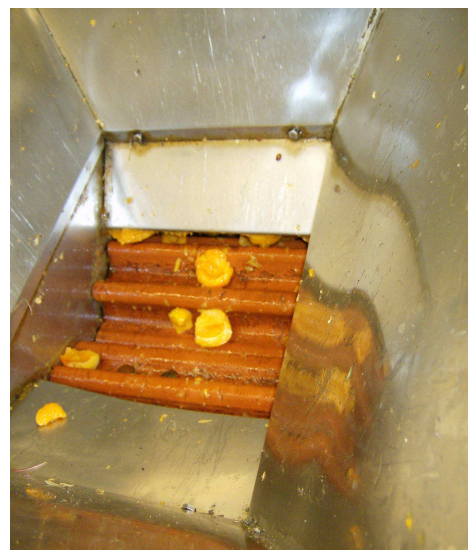
Abb. 11: Walzenmühle von oben, während der Verarbeitung (Ansicht von oben)
