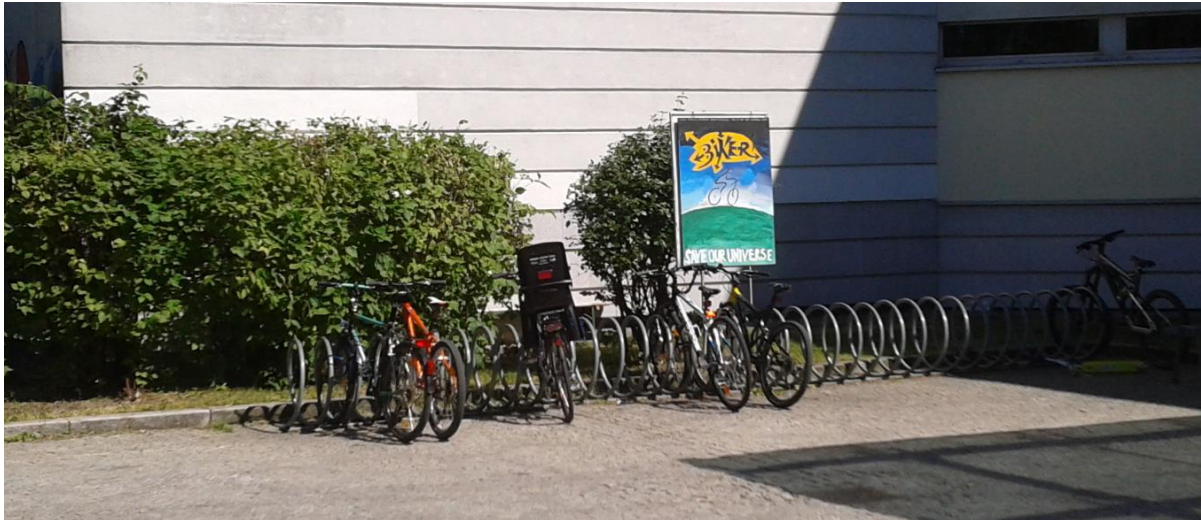
Abbildung 12: Diese Art der Vorderradhalter ist besser als jene der herkömmlichen Vorderradhalter, da die Kräfte bei Schiefelage des Rades nicht nur an einer Stelle wirken und da eine bessere Stabilität gewährleistet wird. Außerdem ist ein Mitabsperren des Rahmens möglich. (Quelle: Aufgenommen von Alexander Straka vor dem Gymnasium auf der Schmelz, Wien 15.)
