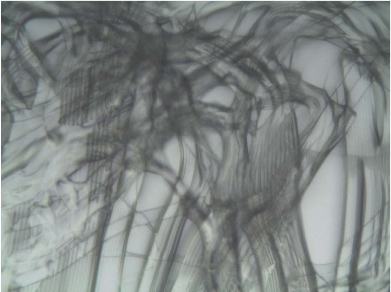
Abb. 17: Probe 2012-10-24-#7, nach dem Entwickeln, 40-fache Vergrößerung. Dieses Photo zeigt einen kleinen Ausschnitt am Rand der Probe, wo ein ausgeprägter „Spaghetti-Effekt“ beobachtet werden kann.
