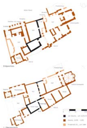
Abb. 42: Krems, Gozzoburg, Baualterplan, Erdgeschoss
