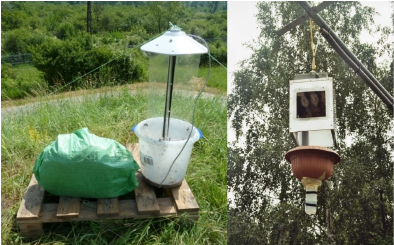
Abbildung 2.3.1: Links: Lichtfalle 2010 (Foto: M. SONEIRA). Rechts: Lichtfalle 2005 montiert auf einem der drei Masten (Foto: C. UNGER). Die „Blendenbox“ entspricht der Bauweise der anderen Lichtfallen des Untersuchungsjahres 2005, abgebildet ist die Kompakstoffleuchten-Variante. Unterhalb des Auffangtrichters (modifizierte Blumenampel) befindet sich der Auffangbehälter mit Tötungsmittel.
