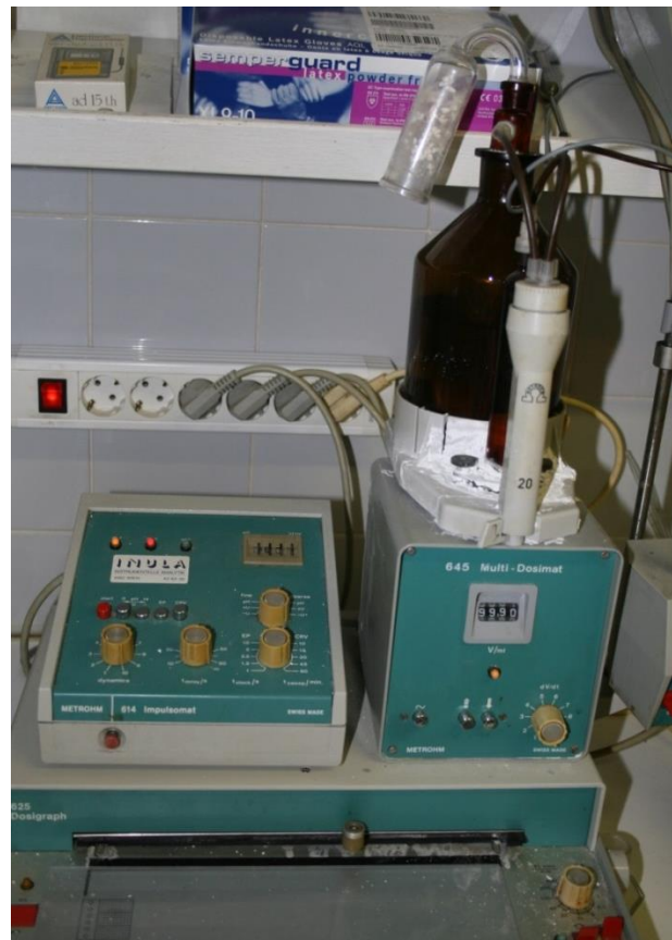
Abb. 25: Bestimmung des pH-Wertes und des Säurewertes anhand eines pH-Meters (DEIM 2013)
