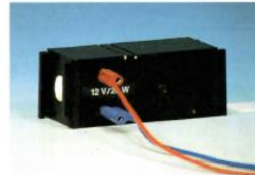
32.2 Lichtquelle für optische Versuche. Die verwendete Glühlampe hat einen sehr kleinen Leuchtkörper (Wendel).
