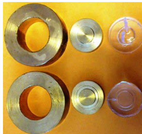
Abb. 22: Gussformen für die Silikonteile (PDMS) der Messzelle
