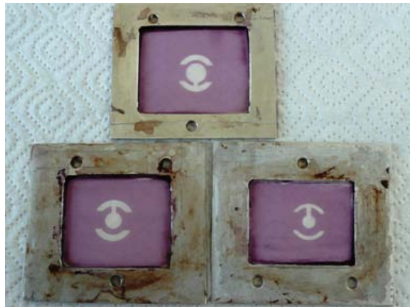
Abb. 110: Verwendete Siebe für die Elektrodendurchmesser 5,5 mm, 7 mm und 9 mm; Elektroden wurden in die Mitte des Quarzes platziert.
