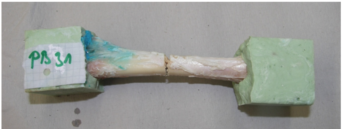
Abbildung 28: Probe pb31: der Knochenspalt ist vor der Messung zusammengegangen, es konnten daher keine Werte ermittelt werden
