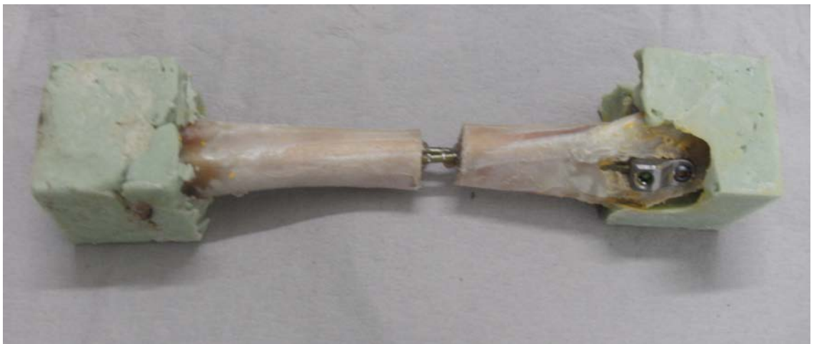
Abbildung 6: Probe nach der Osteotomie
