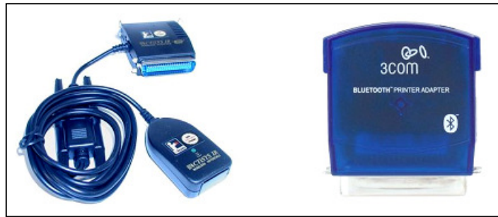
Abb.19: Druckeradapter für Infrarot und Bluetooth. Der Adapter für Infrarot (links) und der Adapter für Bluetooth (rechts) sind an die Parallel-Schnittstelle des Druckers (Centronics Schnittstelle) anzuschließen. Ist auf den PDA des Bibliotheksbesuchers die nötige Druckersoftware installiert, können Druckaufträge vom Gerät direkt an den Drucker übermittelt werden.
