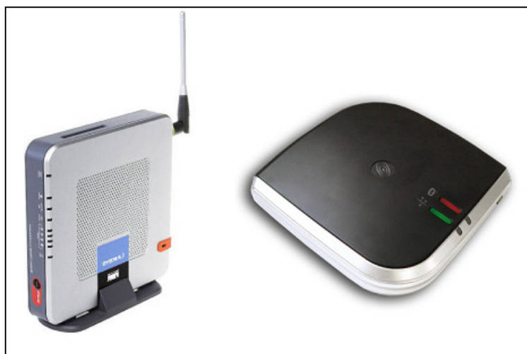
Abb.15: WLAN-Router und Bluetooth-Hotspot. Der drahtlose Internetzugang im Lesesaal der Bibliothek erfolgt zumeist über einen WLAN-Router (linkes Bild) auf Basis des technischen Standards IEEE 802.11. Gleiches leistet ein Bluetooth-Hotspot (rechtes Bild) für Mobilgeräte die über eingebautes Bluetooth verfügen. Er bietet aber dem PDA-Besitzer darüber hinaus noch einen automatisierten Informationsdienst an, wie zum Beispiel aktuelle Öffnungszeiten, sobald er in die Reichweite des Bluetooth-Hotspots kommt.
