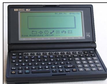
Abb.4: Der HP-95LX. Die Firma Hewlett-Packard brachte 1991 diesen jackentaschengroßen Computer mit Betriebssystem DOS auf den Markt. Das Gerät wurde bei einem frühen PDA-Projekt an der Arizona Health Sciences Library der Universität Tucson eingesetzt.
