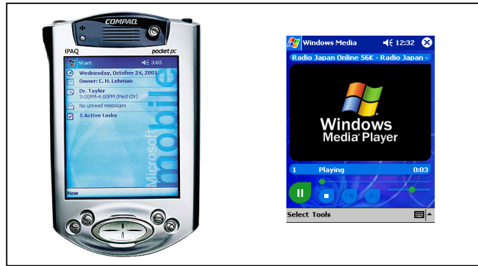
Abb.11: Der PocketPC iPAQ des Herstellers COMPAQ und der Windows MediaPlayer. PocketPCs sind die Konkurrenzprodukte zu den PDAs der Firma Palm. Der hier abgebildete iPAQ mit dem Betriebssystem Windows CE kam 2001 auf den Markt. Microsoft setzte von Anfang an auf Multimedia, Multitasking und Internet und liegt derzeit, nach weltweiten Verkaufszahlen von PDAs, Kopf an Kopf mit Palm.
