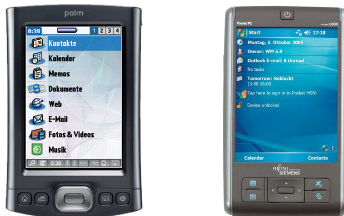
Abb.29: Die verwendeten PDAs für das Projekt. Für den Test der PDA-Produkte wurde ein PalmTX (Palm OS 5.0, linkes Gerät) und ein PocketLOOX C550 (Windows Mobile 5.0, rechtes Gerät) eingesetzt. Bei der Anschaffung wurde Wert auf großen Bildschirm, schnelle CPU, Speichererweiterung mit SD-Card und eingebautes WLAN gelegt.
