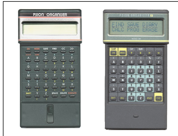
Abb.3: Der Psion Organiser I und II. Die taschenrechnerartigen Computer der Firma PSION können als die ersten, auch kommerziell erfolgreichen PDAs bezeichnet werden. Der Organiser II wurde weltweit rund 1 Million Mal verkauft. Die Dateneingabe erfolgte noch über Tasten und nicht über den später gebräuchlichen Stylus.
