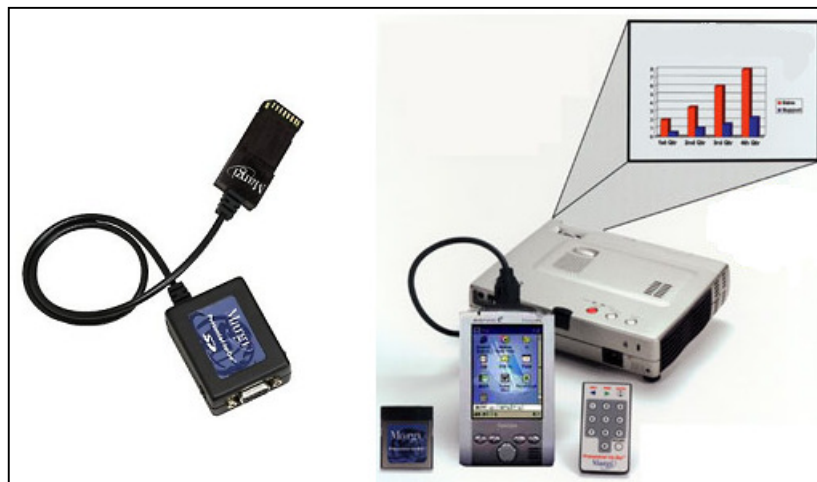
Abb.23: PDA-Anwendungen direkt via Beamer präsentieren. Die Zusatz-Hardware verbindet den PDA über den Steckplatz für die Speichererweiterungskarte und einem Wandler direkt mit dem Beamer. Am PDA muss eine Steuerungssoftware installiert werden, die auch die Fernbedienung des PDAs ermöglicht.
