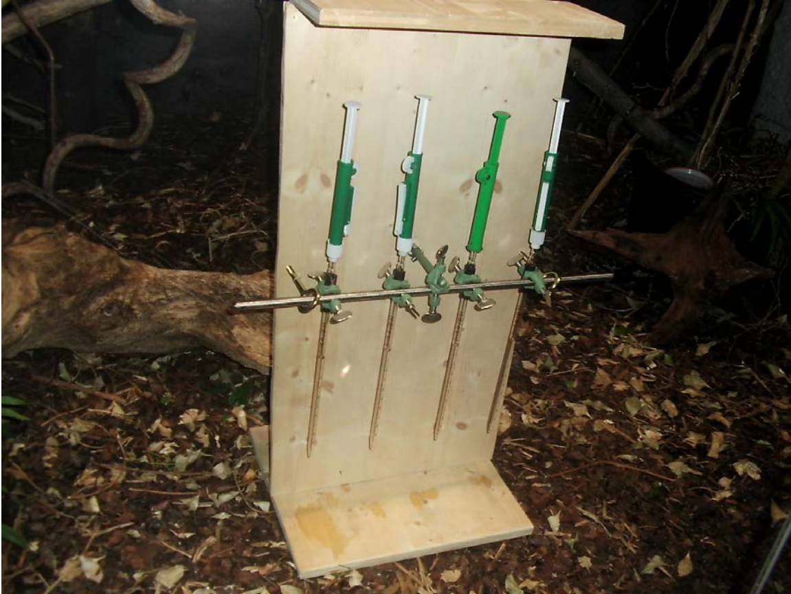
Abb. 7: Holzgestell mit vier Pipetten, die an einem Stativ fixiert sind.
