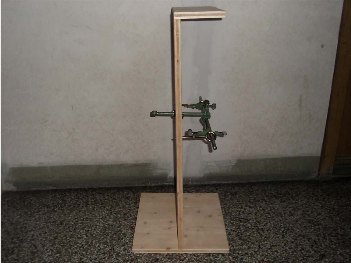
Abb. 8: Holzgestell (seitlich) mit Stellplatte unten zur Stabilisierung und Schutzplatte oben zum Schutz der Saugvorrichtungen der Pipetten
