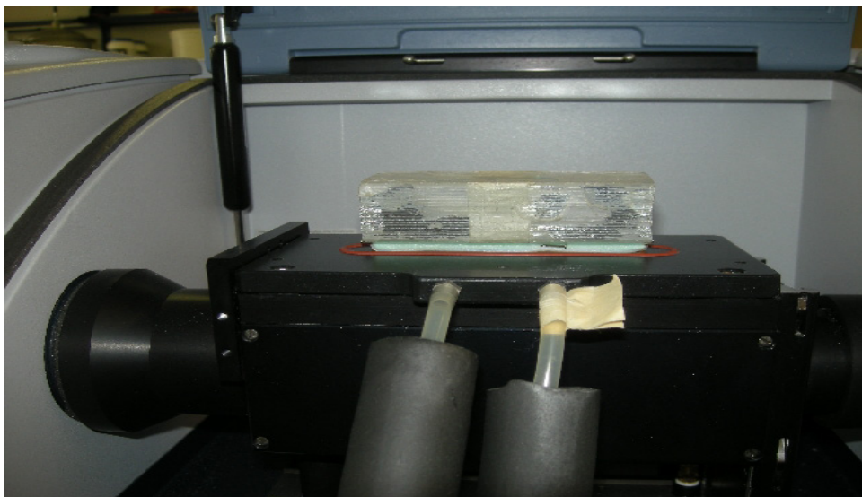
Abb. 22: Probenraum mit aufgebrachtter Hautprobe am ZnSe-Kristall und Gewichtsbeschwerung
