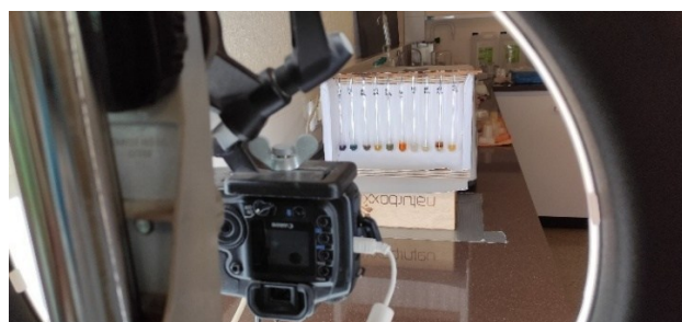
Abbildung 14 (links) und 15 (rechts): die stationäre Fotostation, an der die Dokumentation bei Tageslicht erfolgte. Zu sehen ist die Canon Kamera, das Ringlicht, sowie die vom Laborleiter Mag. Burschowsky gebaute stationäre Konstruktion zum Einhängen der Reagenzgläser.
