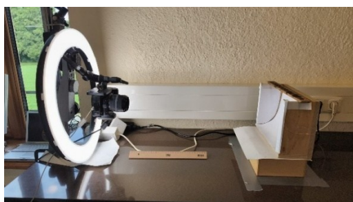
Abbildung 14 (links) und 15 (rechts): die stationäre Fotostation, an der die Dokumentation bei Tageslicht erfolgte. Zu sehen ist die Canon Kamera, das Ringlicht, sowie die vom Laborleiter Mag. Burschowsky gebaute stationäre Konstruktion zum Einhängen der Reagenzgläser.
