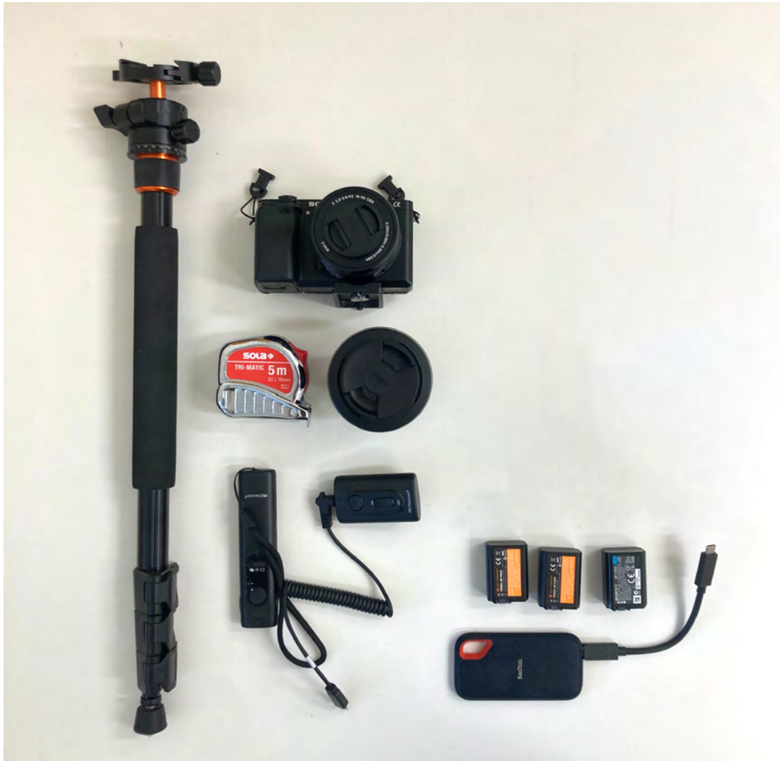
Abbildung 2.3.: Ausrüstung zur Anfertigung der Innenfotos und der Skalierung: Sony Alpha 6300, Ersatzakkus, Fernauslöser PROfezzion, Externe SSD Sandisk, Objektiv Sigma 30 mm, Monopod KF Concept, Maßband Sola Tri-Matic 5 m.
