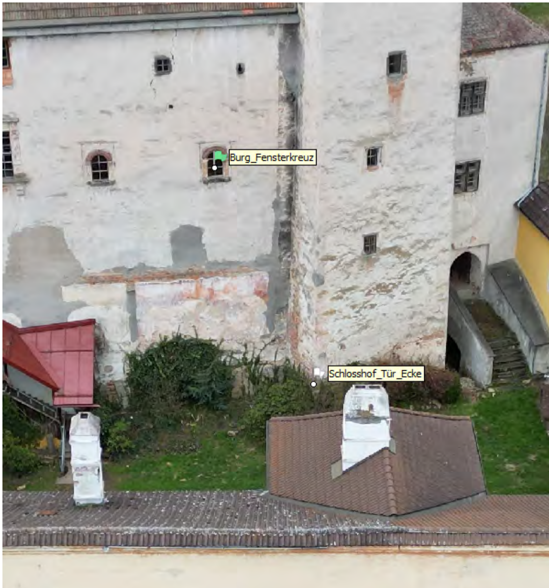
Abbildung 2.8.: Marker zum manuellen Alignment individueller Drohnenfotos (Screenshot). In grün: manuell platzierter Passpunkt; weiß: von Metashape erstellter Passpunkt (inkorrekt und daher nicht verwendet).
