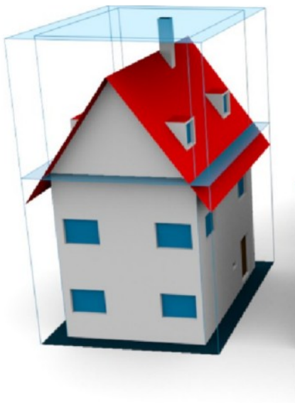
Abbildung 38: verschiedene Konstruktions-Möglichkeiten für ein LoD1-Gebäude (Lehner und Dorffner 2020)
