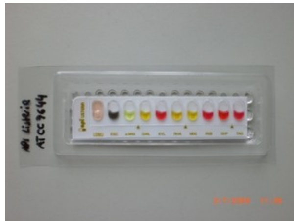
Abbildung 22: API Listeria Testkit nach 24 stündiger Bebrütung und Zugabe von ZYM B Reagenz
