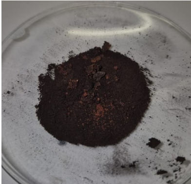
Abbildung 26: Überreste nach dem Aufglühen. Die rötlich/braune Färbung deutet auf elementares Kupfer hin. Quelle: Eigene Aufnahme.
