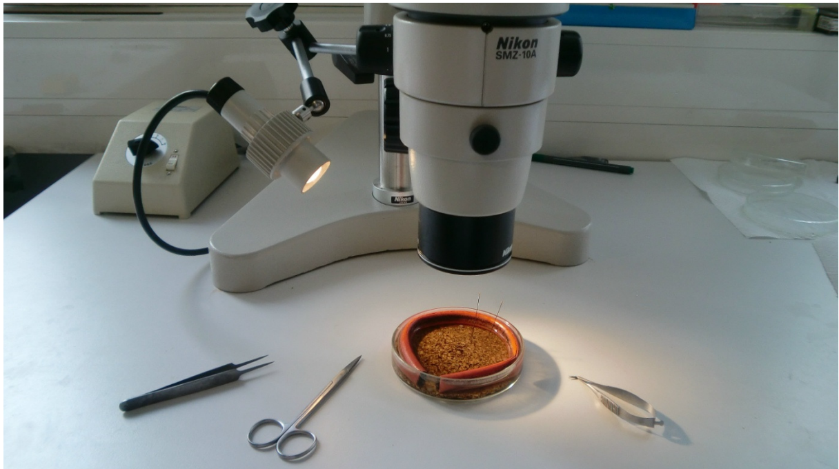
Abbildung 3: Auflichtmikroskop und Werkzeuge
