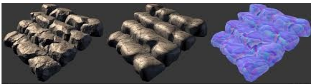
Abbildung 37: High-Poly-Modell (links), Low-Poly-Model (mitte), Normal Map (rechts) Quelle: PolycountWiki, unter: http://wiki.polycount.com/wiki/Normal_map letzter Zugriff am 13.05.2025
