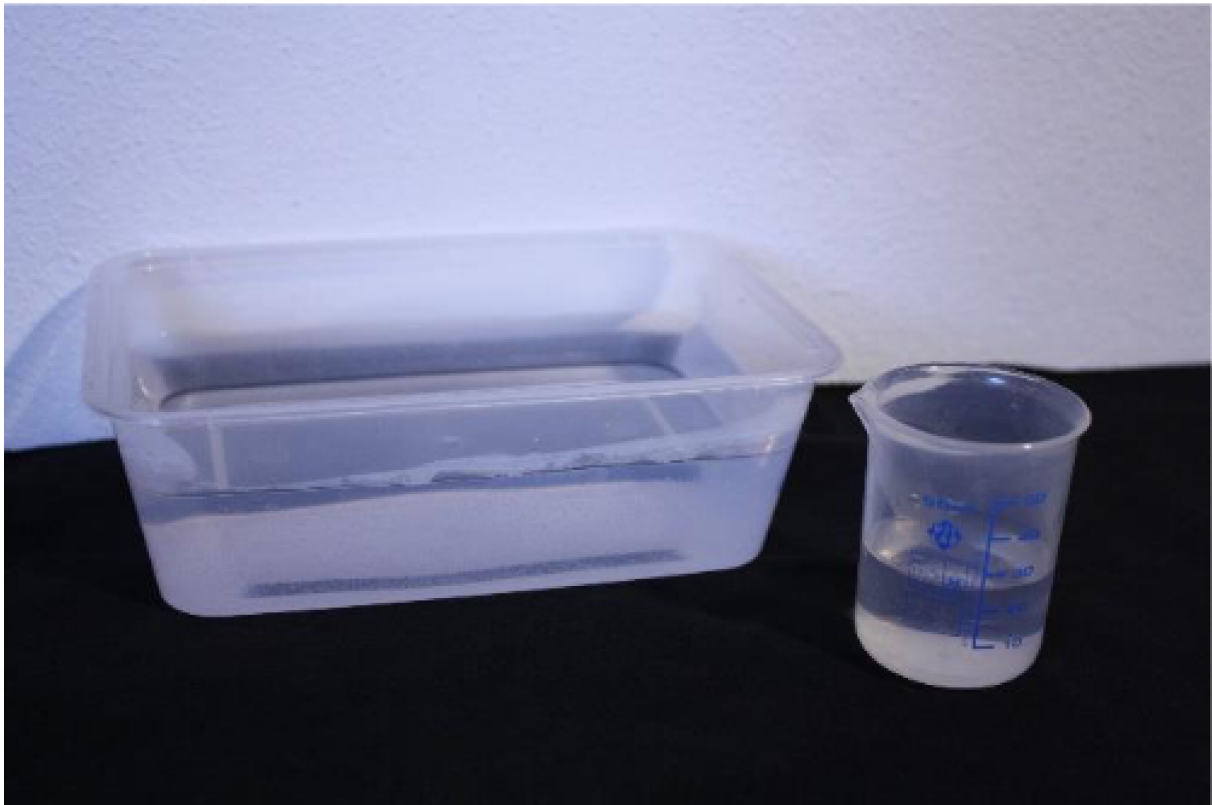
Abbildung 13: Plastikgefäß mit 480 ml Wasser und kleinem Messbecher als Versuchsaufbau für jede Schülergruppe.
