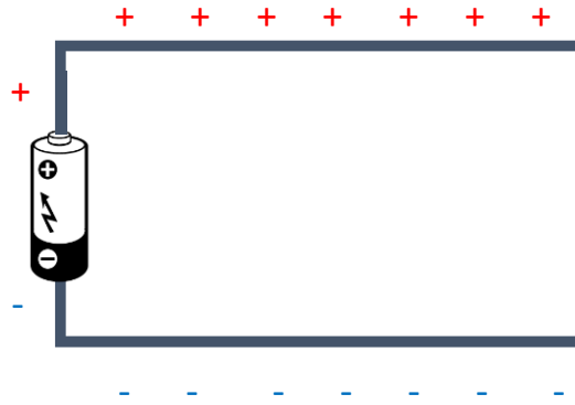
Abbildung 11: Oberflächenladungen in einem offenen Stromkreis. Die Ladungen verteilen sich im ersten Moment gleichmäßig entlang der Kabel und bleiben dann statisch auf der Leiteroberfläche. Zu beachten ist, dass die Ladungen hier exemplarisch an einer Seite des Leiters gezeichnet werden, sich aber tatsächlich rund um den Leiter anordnen (siehe Abbildung 8).
