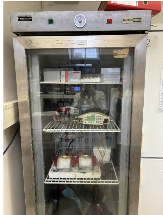
Abbildung 8: Aufgetragene Proben von Gel 5 und 6 vor dem Lauf (links) und der Elektrophorese-Run der Gele im Küleq 0/15 ° (rechts).
