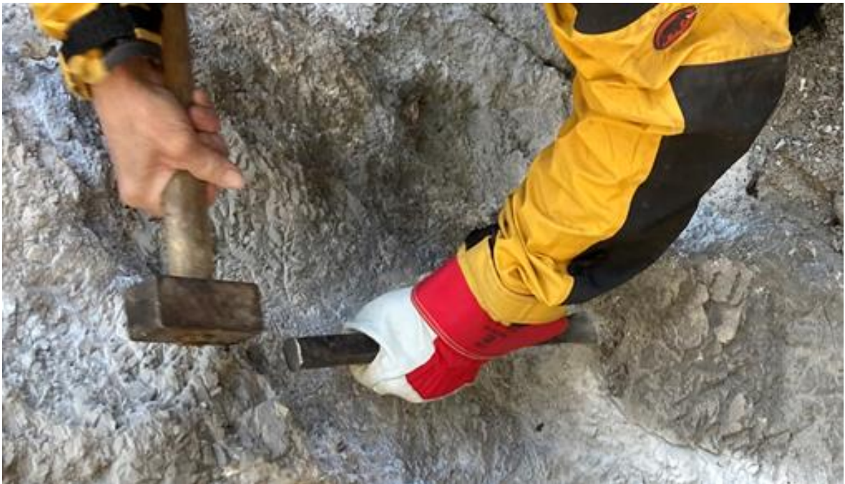
Abbildung 20: Abschlagen des Gesteines mittels Meisel und Hammer, um Proben für das Labor zu gewinnen.
