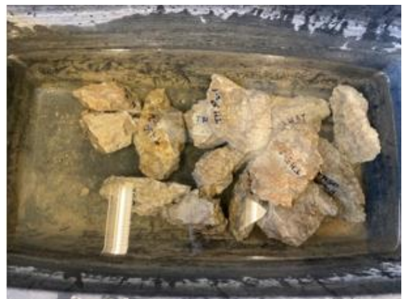
Abbildung 15: Der Trocknungsofen mit Gesteinsproben (links) und den gesättigten Proben in Wasser (rechts).
