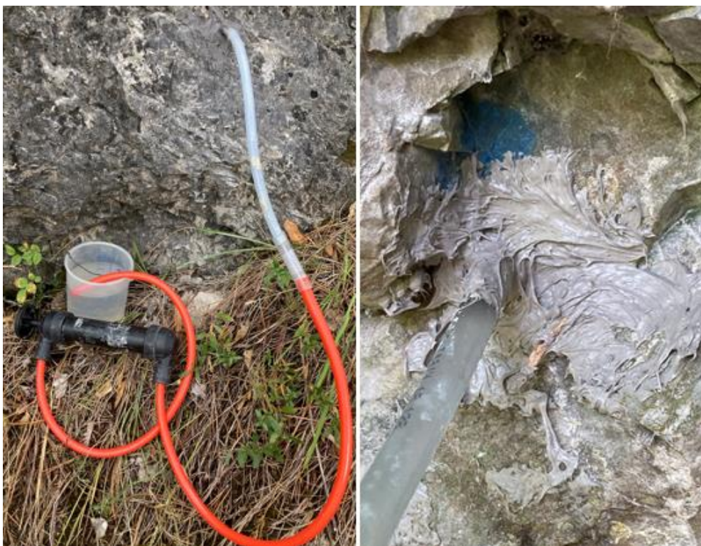
Abbildung 18: Die Dichtprüfung mittels Pumpe (links) und die Abdichtung des Schlauches mittels Dichtstoff (rechts).
