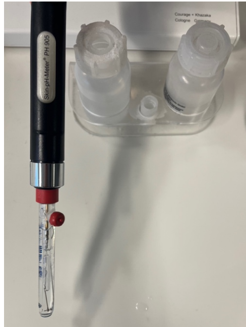
Abbildung 18: Skin-pH-Meter®: Kombi-Gaselektrode mit Elektrolyt- und Waschlösung
