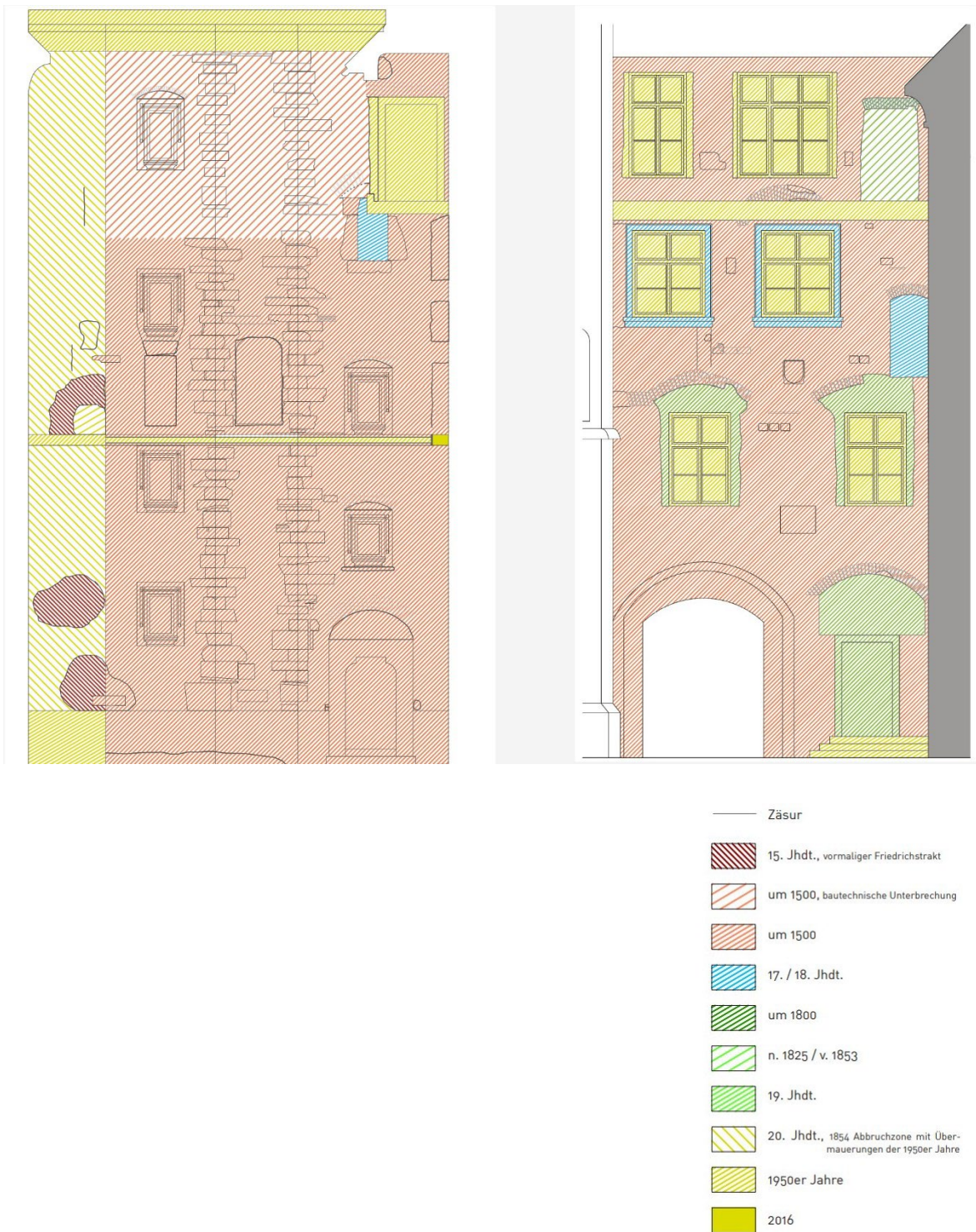
Abb. 87 Bauphasenplan des Turmes der Doppelwendeltreppe (links) und der Südfassade des Maximilianstrakts (rechts), Zechner Denkmal Consulting GmbH.
