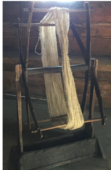
Abbildung 12: Fertiges Garn nach dem Spinnen auf der Garnhaspel
