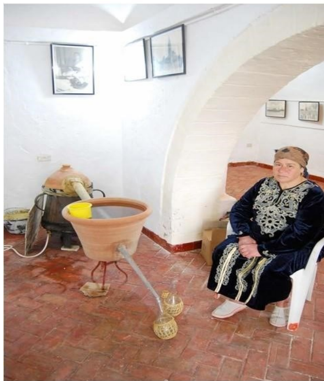
Abbildung 4 Heutige traditionelle Hydrodestillation in Tunesien (Region "Nabeul") [20]
