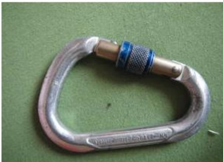
Abbildung 46 Screenshot Karabiner mit Verschlussicherung
