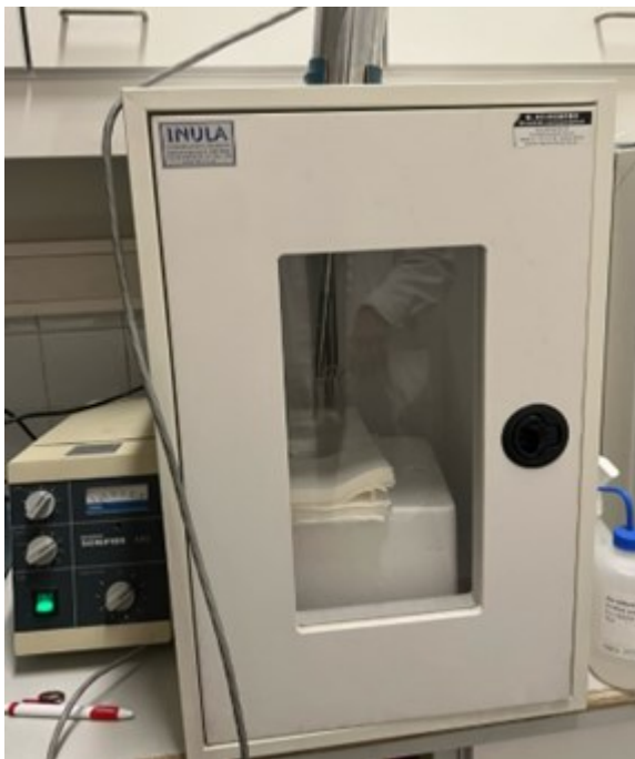
Abbildung 7: Sicherheits-Sonifikationskammer (Quelle: eigene Aufnahme)
