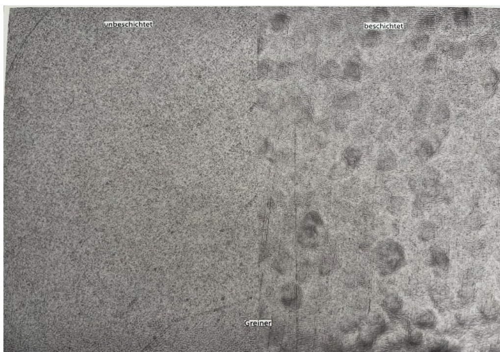
Abbildung 15: Oberfläche der Greiner-Platte vor und nach der Beschichtung mit HES-DFO (Quelle: eigene Aufnahme)
