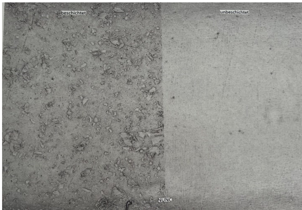
Abbildung 14: Oberfläche der NUNC- Platte vor und nach der Beschichtung mit HES-DFO (Quelle: eigene Aufnahme)
