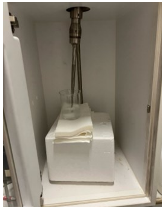
Abbildung 8: Lösung mit eingetauchter Ultraschallsonde in der Sicherheits- Sonifikationskammer (Quelle: eigene Aufnahme)
