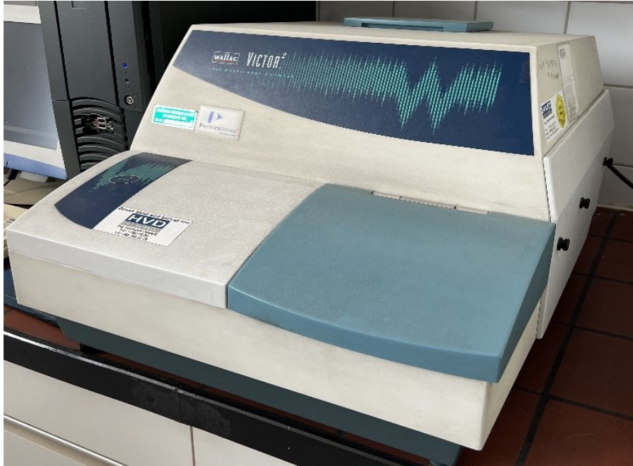
Abbildung 9: Das temperierte Plattenlesegerät Victor2 von HVD (Quelle: eigene Aufnahme)
