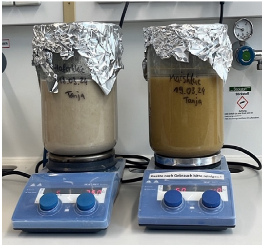
Abbildung 9: AX-Extraktionsprozess Mais- und Haferkleie bei pH 11, 50°C, 2 h
