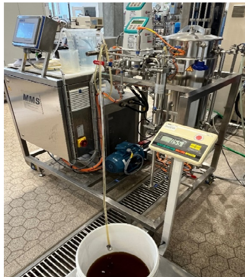
Abbildung 15: Ultrafiltrationsanlage MMS (Urdorf, Schweiz) im Technikum am Institut für Lebensmitteltechnologie der Universität für Bodenkultur Wien
