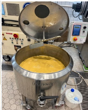
Abbildung 13: Extraktion der Maiskleie im Rühr-kessel ( \text{Ca}(\text{OH})_2 , pH11, 50 °C, 2 h)
