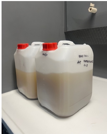
Abbildung 10: AX-Ausfällung mit Ethanol (70 %)
