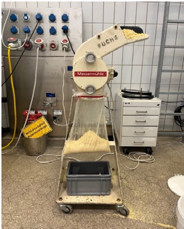
Abbildung 12: Vermahlung der Maiskleie mittels Messermühle (1 mm Korngröße)
