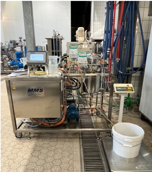
Abbildung 15: Ultrafiltrationsanlage MMS (Urdorf, Schweiz) im Technikum am Institut für Lebensmitteltechnologie der Universität für Bodenkultur Wien
