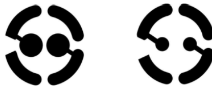
Abb. 7: Der Quarz wird für Flüssigphasenmessungen mit zwei ungleich großen gegenüberliegenden Elektroden beschichtet.
